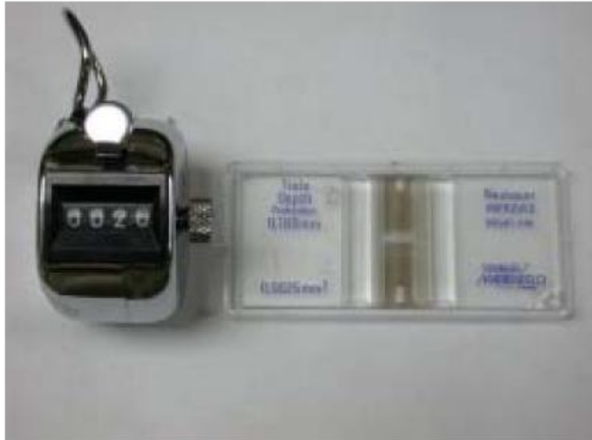
圖 3-7 血球計數盤、蓋玻片、計數器
