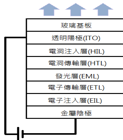
圖 1 典型多層有機發光二極體架構
