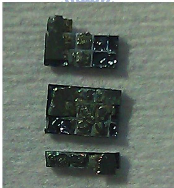
圖4-2 P-type 900°C鍺晶片熔融圖
