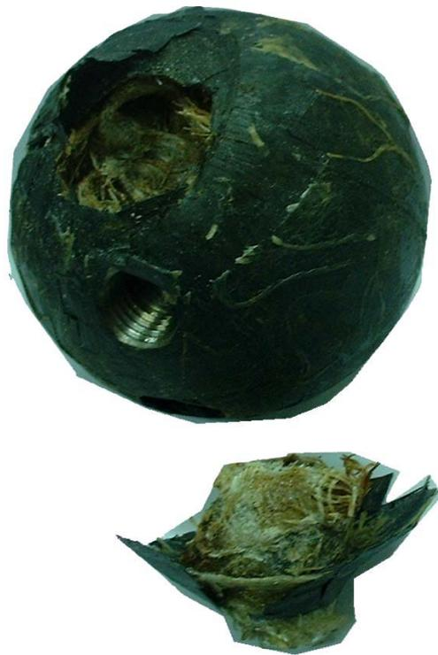
圖 6-5 使用壁虎釘破壞之情形
