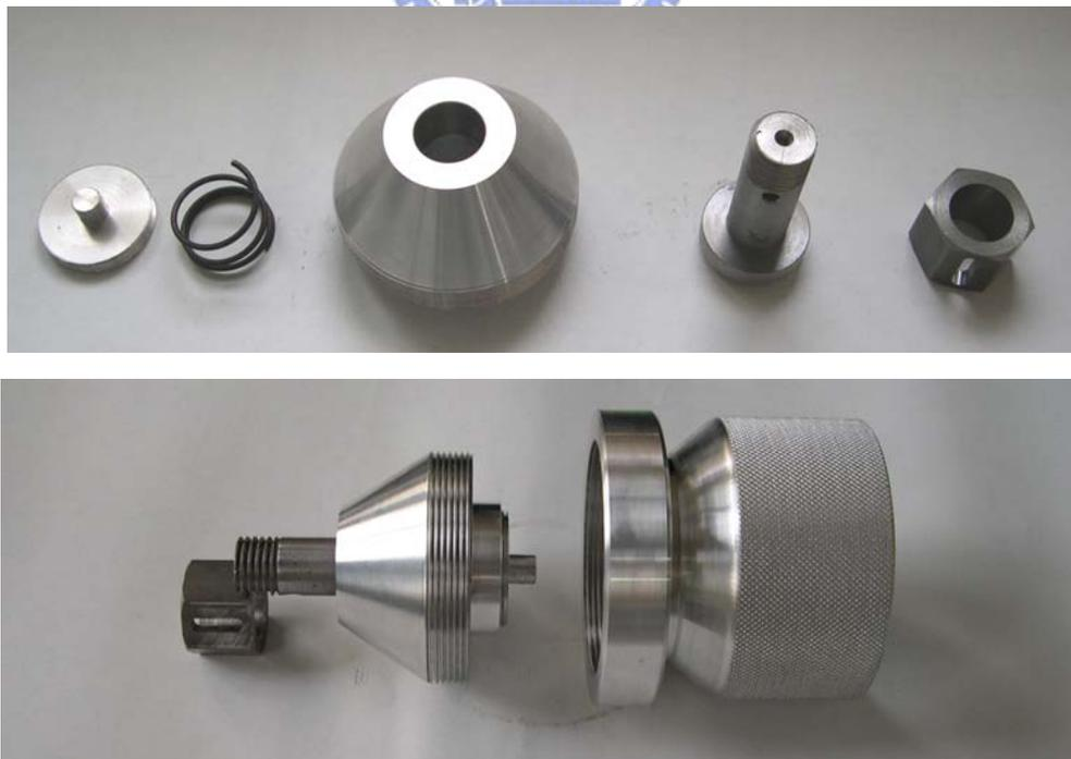
圖 3-4 改良後的桿件端接頭
