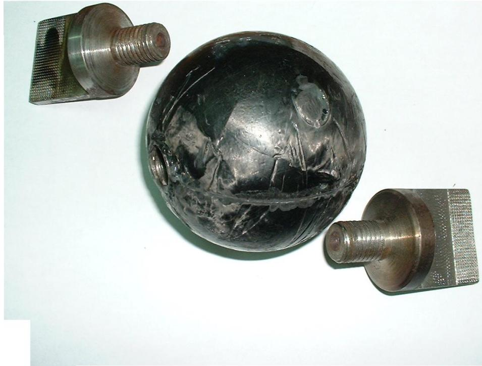
圖 7-1 拉伸試驗的夾具與試體
