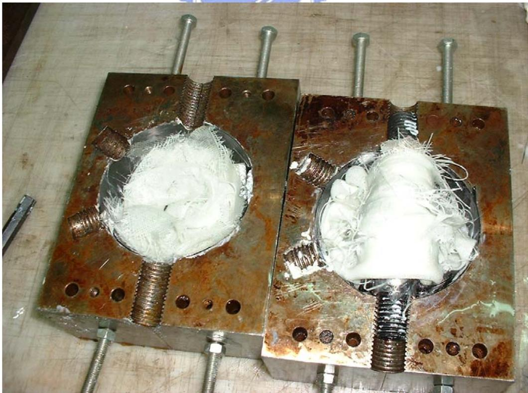
圖 6-13 將管接頭裝置在模具圖
