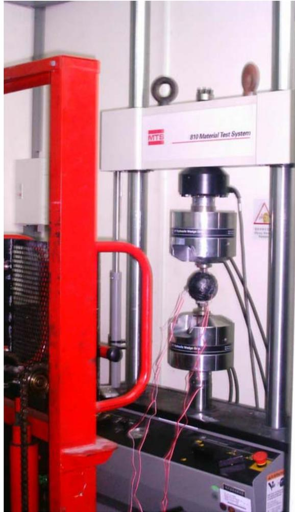
圖 7-3 試體架設在拉伸試驗機上
