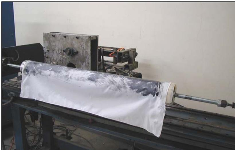
圖 2-26 第二層 peel ply
