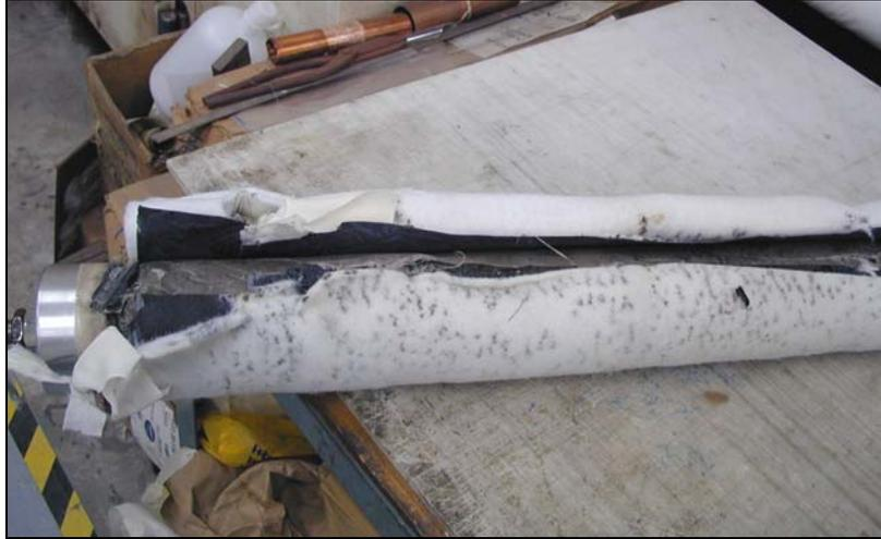
圖 2-30 將包覆材拆下
