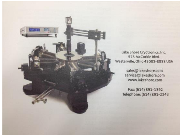
圖 3.4 為探針量測系統及 LakeShore 336 溫控器
