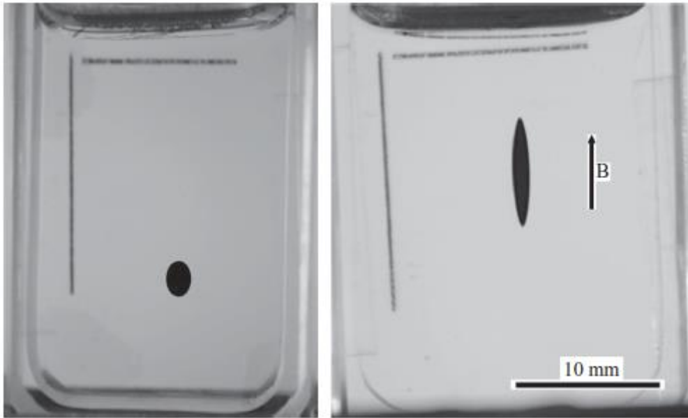
圖 1-9 磁性液滴在非磁性流體中外加垂直磁場所產生拉身形變現象
