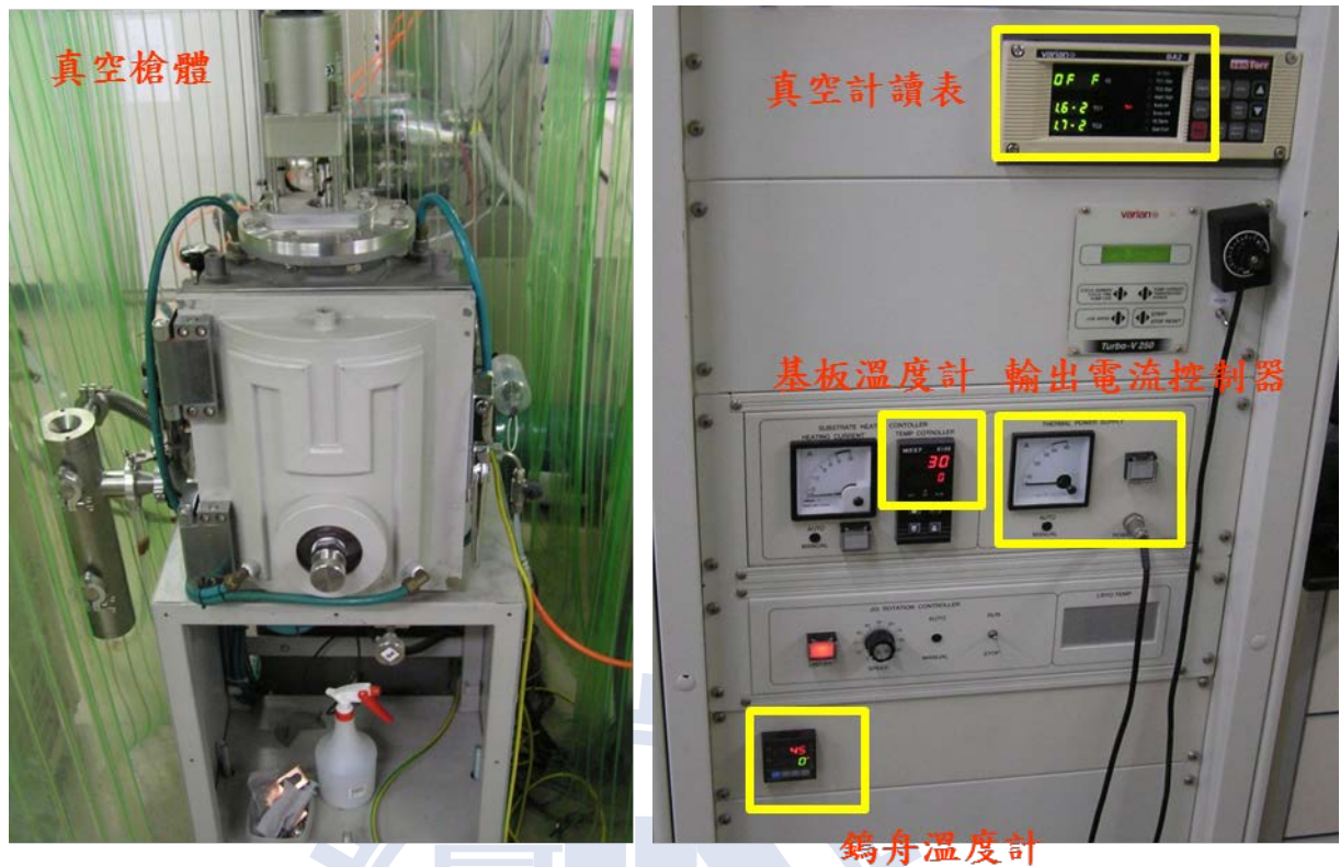
圖 3-3 本研究之實驗所使用之熱阻式蒸鍍系統。
