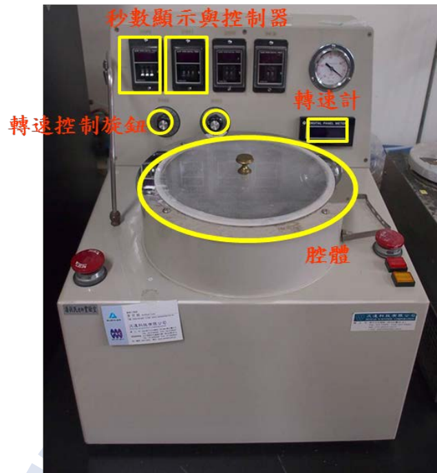
圖 3-4 本研究之實驗所使用之旋轉塗佈機。
