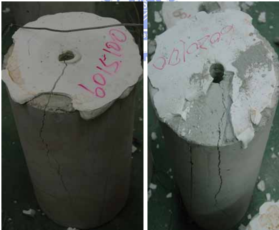
圖 4-6 100°C 下 D19 未塗裹鋼筋埋深 15d_b 試體的破壞模式(左圖)
