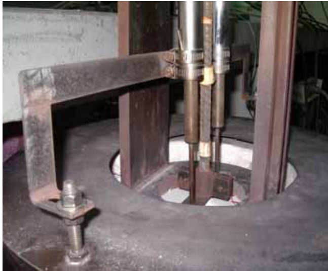
圖 3-21 安置 LVDT，裝設完成開始加熱
