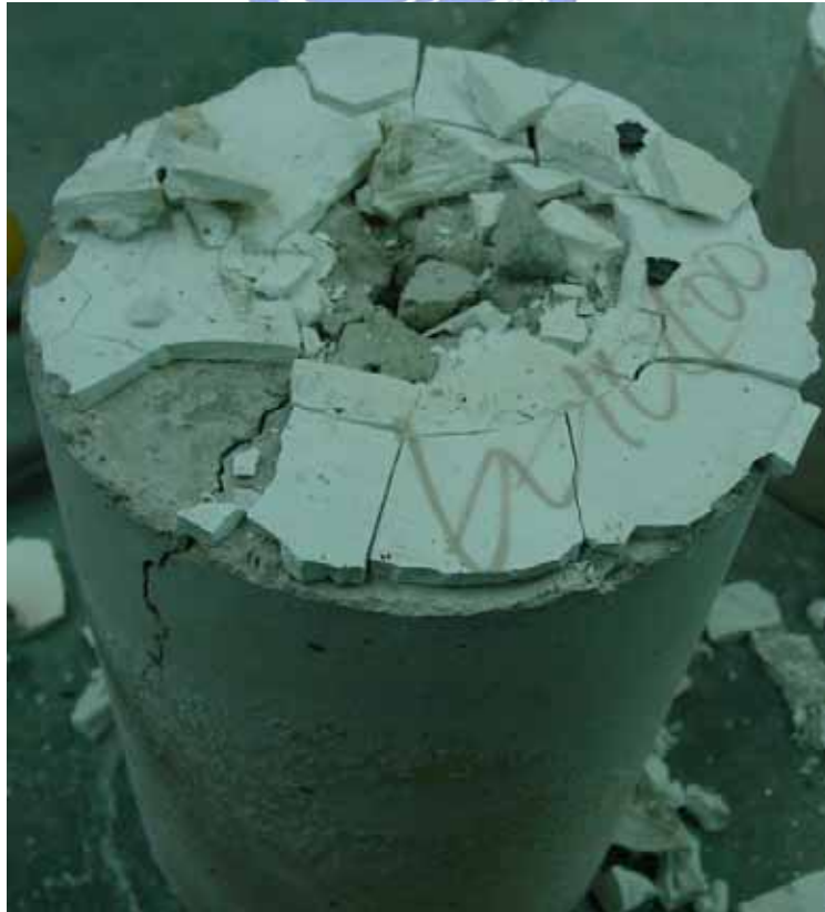
圖 4-14 中心溫度 400°C，D19 一般鋼筋埋深 10d b 試體的劈裂情形
