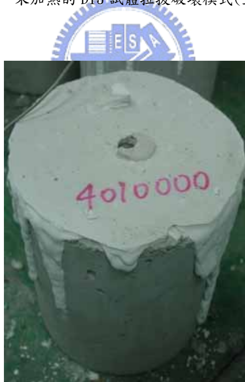
圖 4-2 未加熱的 D13 試體拉拔破壞模式(側視圖)
