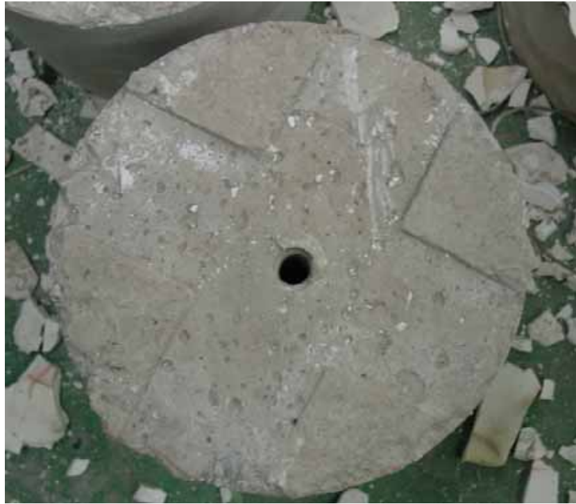
圖 4-1 未加熱的 D13 試體拉拔破壞模式(上視圖)
