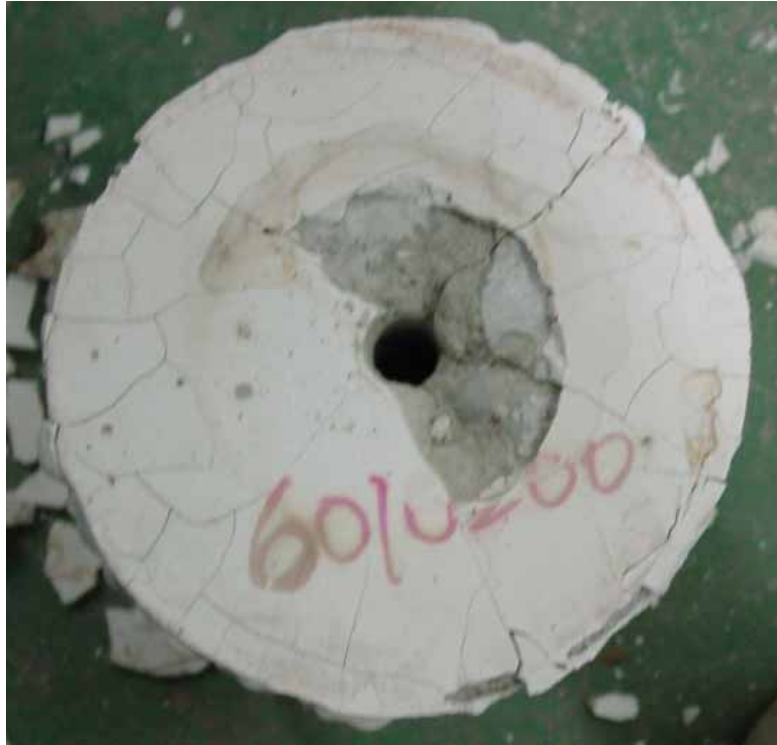
圖 4-10 200°C D19 未塗裹鋼筋埋深 15d b 試體的燒裂情形
