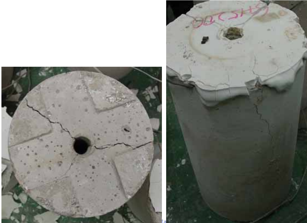
圖 4-13 200°C D19 雙層塗裹 ECR 埋深 15d b 試體的劈裂情形
