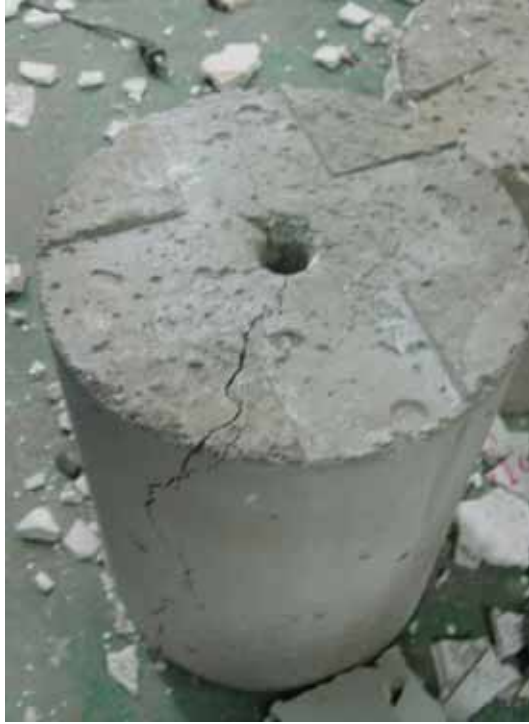
圖 4-5 100°C 下 D19 未塗裹埋深 10d_b 試體的破壞模式
