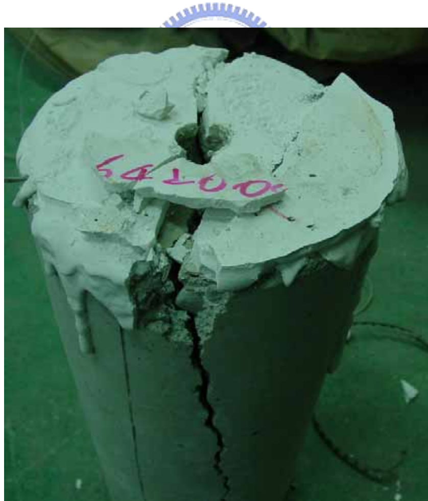
圖 4-4 未加熱的 D19 雙層塗裹厚度 ECR 試體其破壞模式(爆裂式劈裂破壞)
