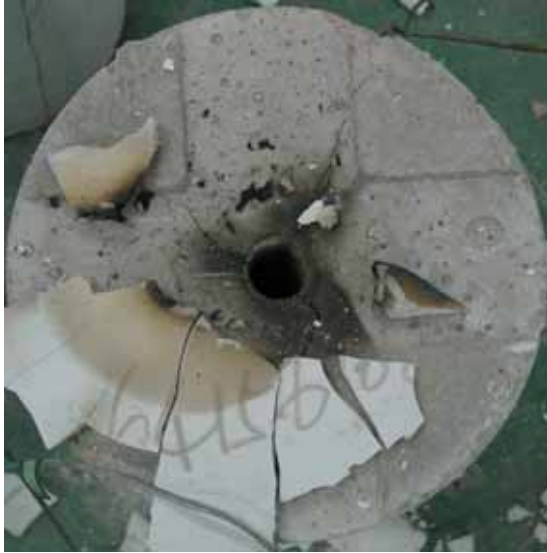
圖 4-17 600°C D19 15d b 試體頂面外觀 圖 4-18 600°C D19 15d b 試體側面外觀
