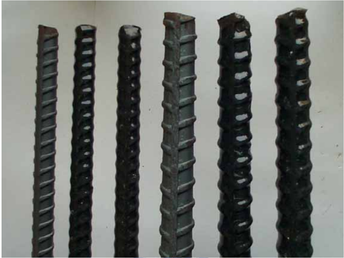
圖 3-2 普通鋼筋在環氧樹脂塗佈前後之外觀
