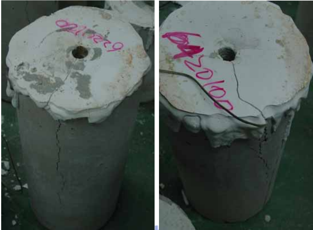
圖 4-8 100°C D19 試體單層及雙層塗裹 ECR 在埋深 20d_b 時的破壞模式
