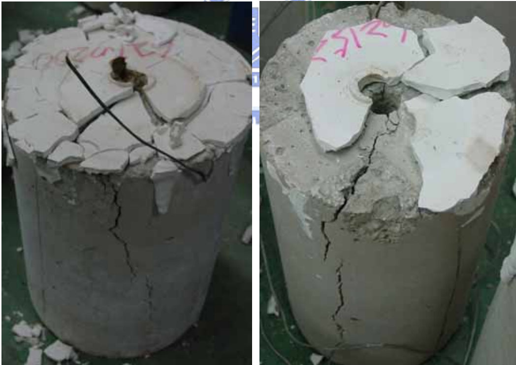
圖 4-11 200°C D19 單層塗裹 ECR 埋深 10d b 試體的劈裂情形(左圖)
