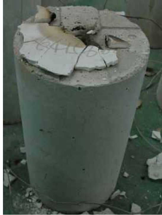
圖 4-17 600°C D19 15d b 試體頂面外觀 圖 4-18 600°C D19 15d b 試體側面外觀
