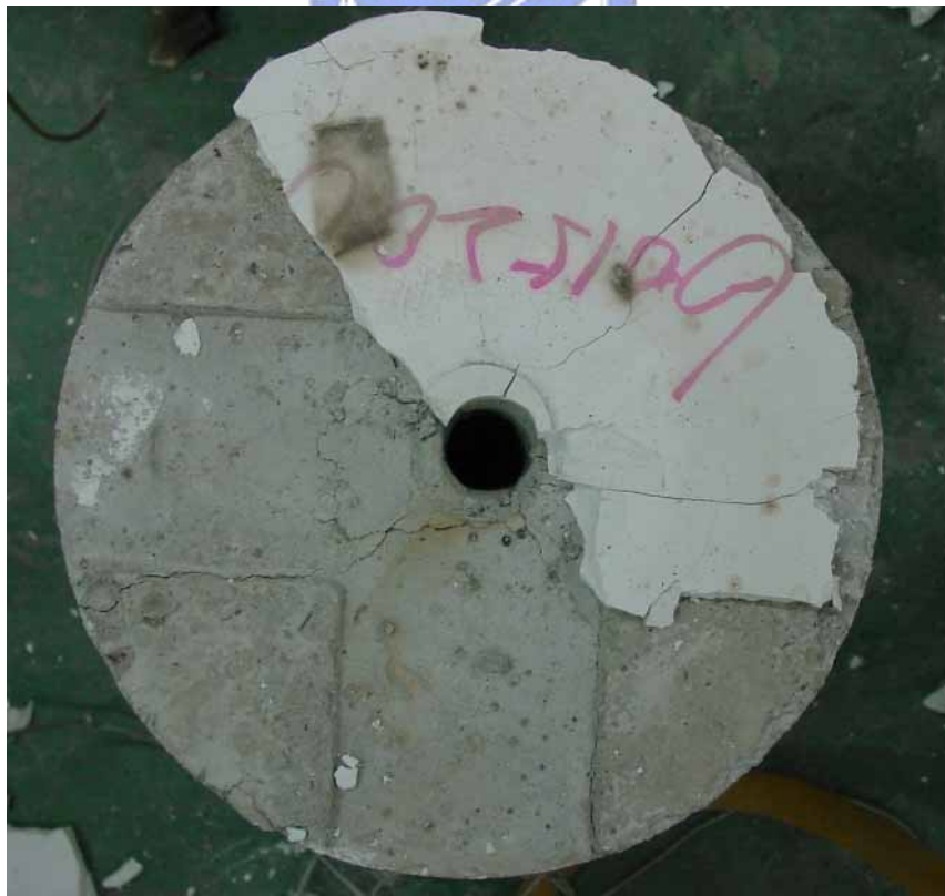
圖 4-9 200°C D19 未塗裹鋼筋埋深 10d_b 試體的燒裂情形
