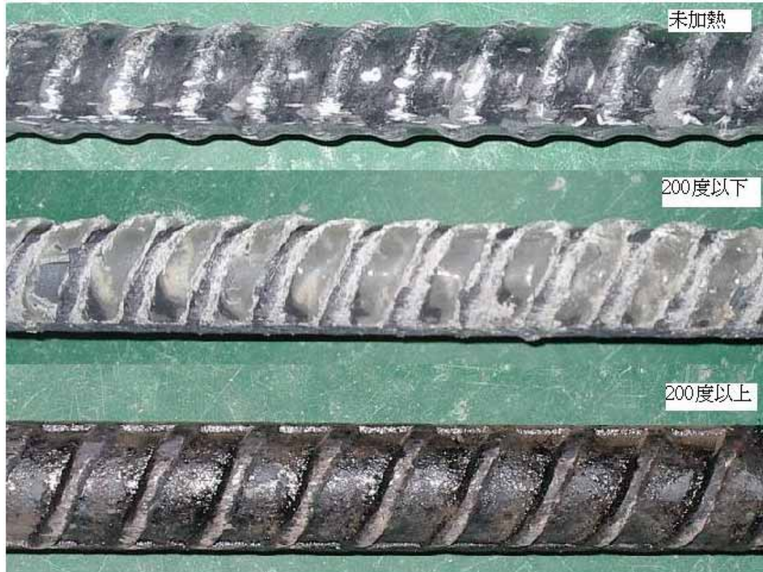
圖 4-20 各種加熱溫度下 ECR 鋼筋拔出後的外觀
