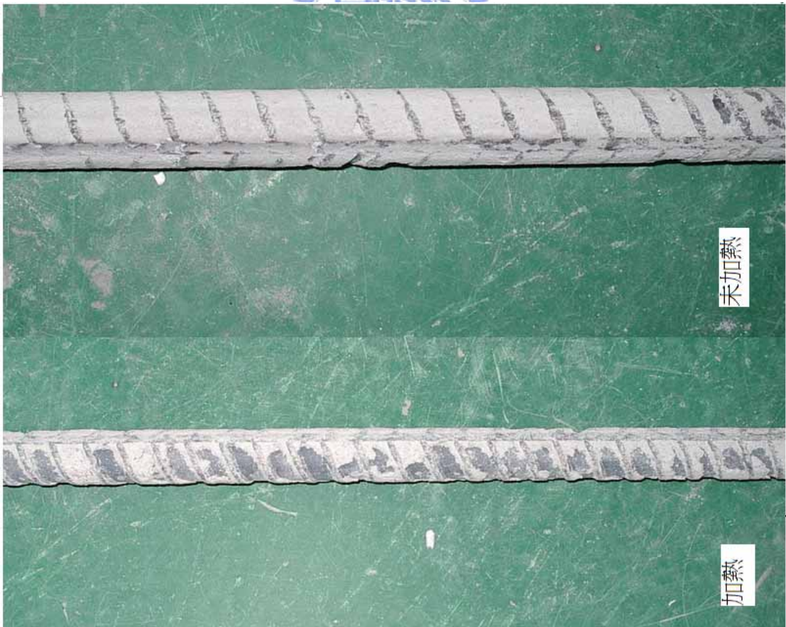
圖 4-19 加熱與未加熱試體埋置的一般鋼筋拔出後外觀
