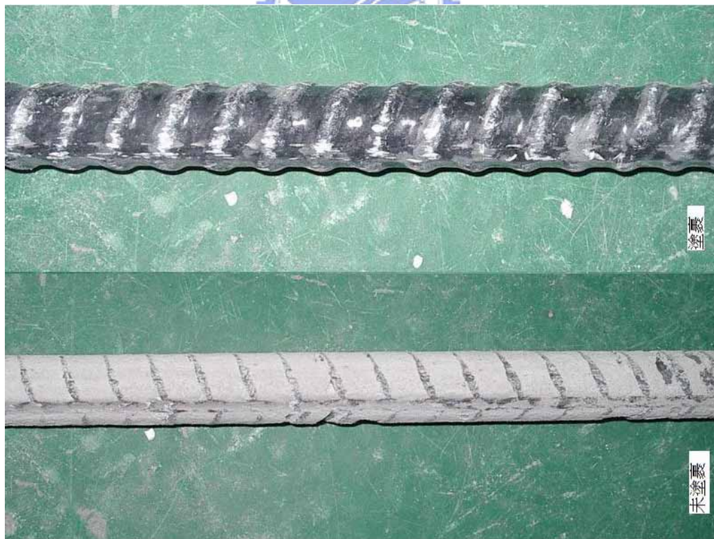
圖 4-21 常溫下 ECR 與一般鋼筋拔出後的外觀
