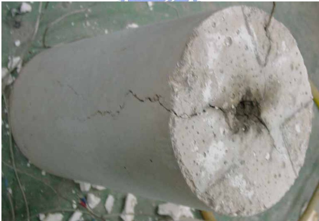
圖 4-16 中心溫度 400°C，D19 ECR 埋深 15d b 試體的劈裂情形
