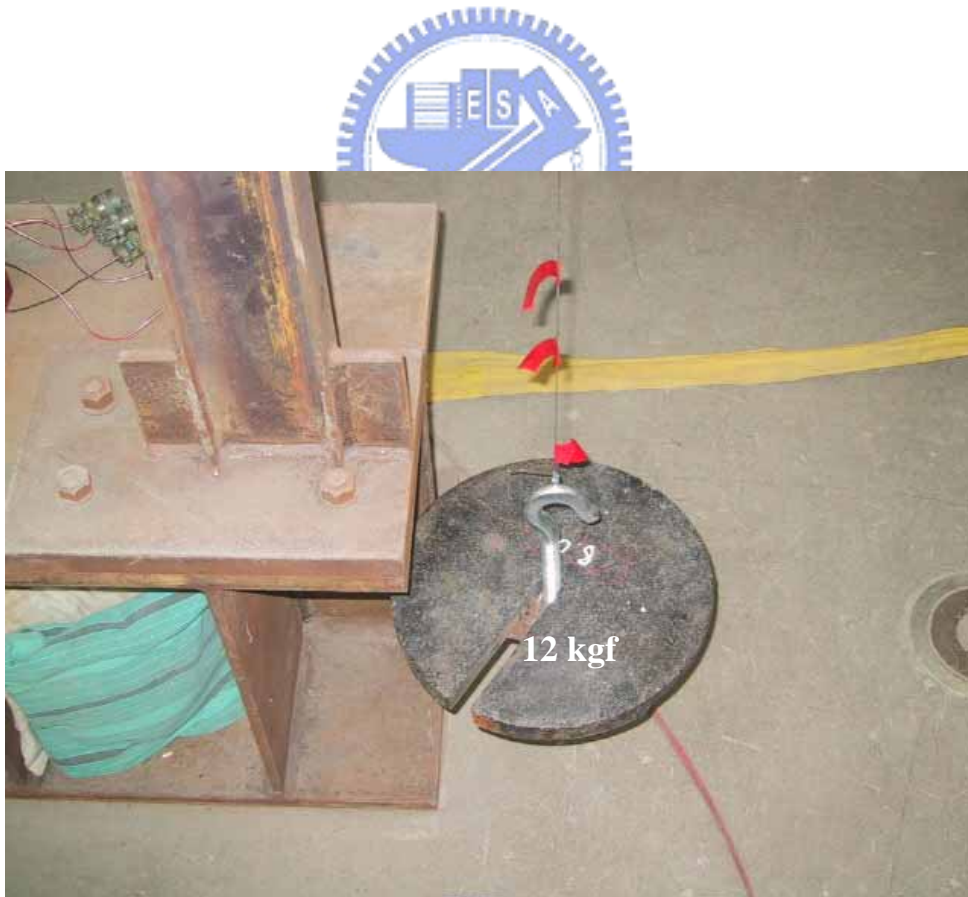
圖 4.18 (b) 自由振盪試驗之側向施力示意圖
