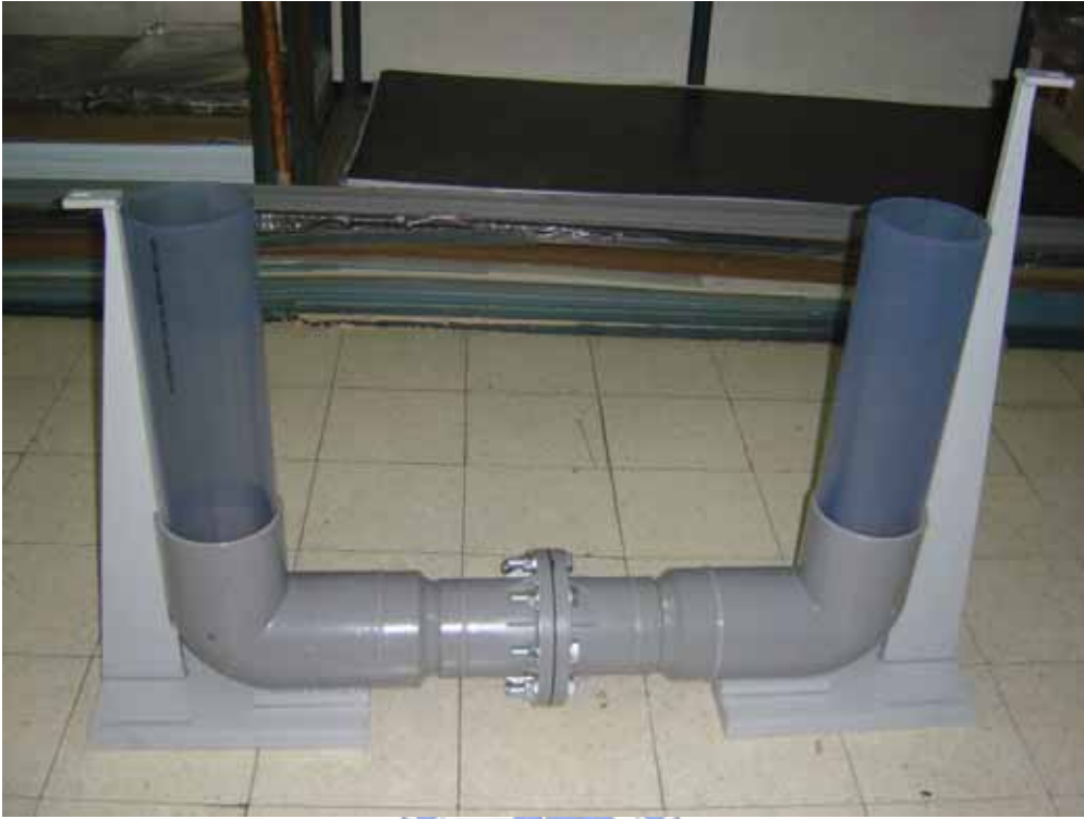
圖 5.1 變斷面 TLCD 實體圖 ( d=0.8\text{m} )
