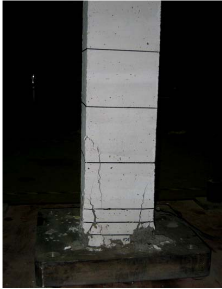
(a) 混凝土保護層產生裂縫： 位移達 1.06\Delta_{p_0} 時
