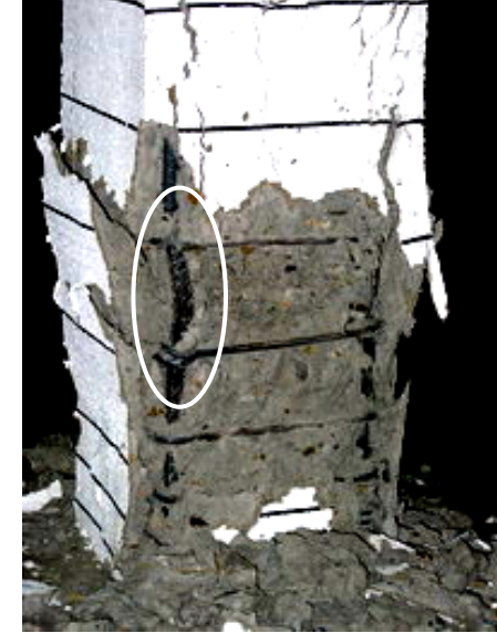
(c) 主筋發生挫屈： 位移達 2.27\Delta_{pu} 時
