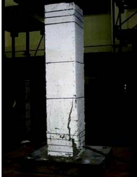
(a) 保護層產生裂縫： 位移達 1.29\Delta_{pu} 時
