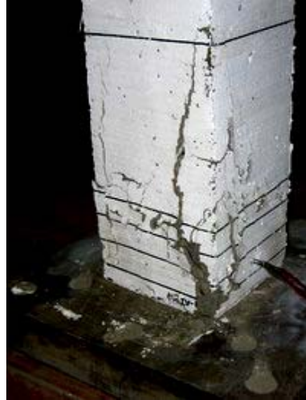
(b) 混凝土明顯開裂： 位移達 1.34\Delta_{pu} 時
