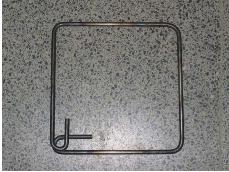
照片 3.1 本研究試體採用之圍束箍筋型式
