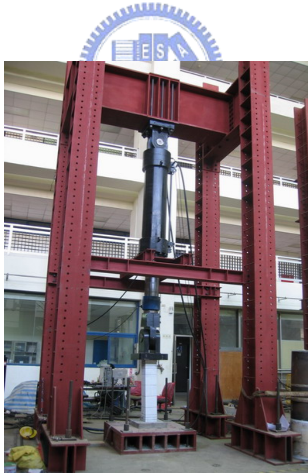
照片 3.2 本研究以 MTS 加壓器進行 SRC 短柱抗壓試驗之情形
