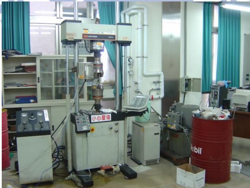
圖 3-3 Instron8501 型萬能試驗機
