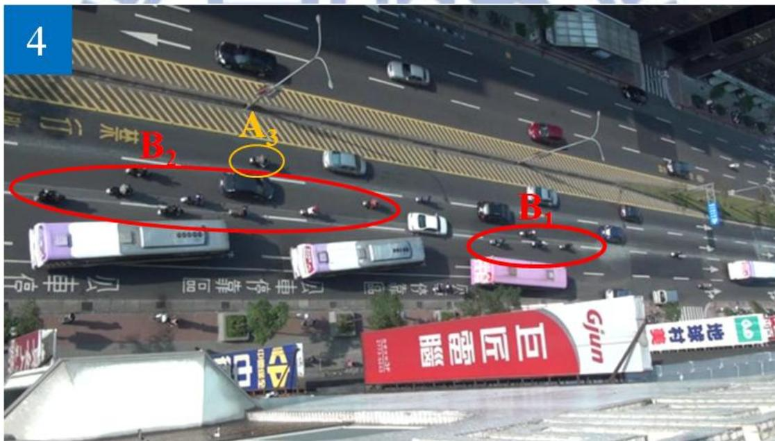
(d) 駕駛速度快的 A<sub>3</sub> 脫離機車群向左偏移至最內側車道超車，B<sub>1</sub> 機車群找到右前方較寬縫隙避車移動
