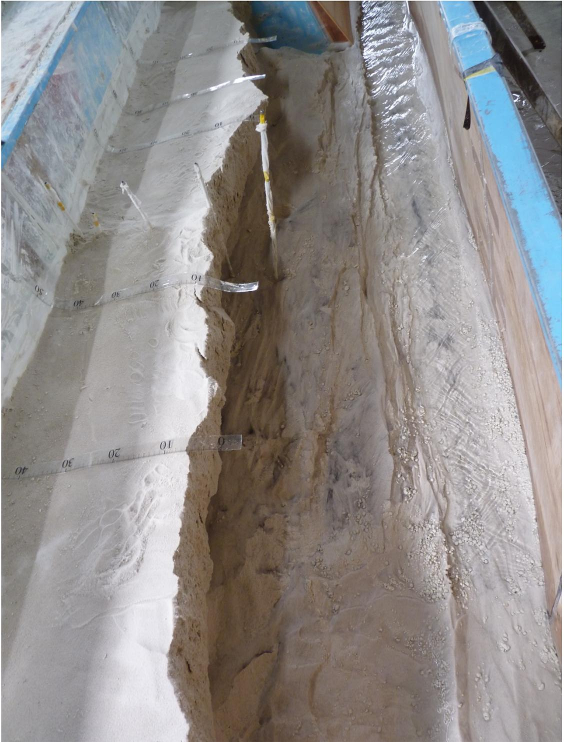
圖 4.24 試驗結束後退水圖
