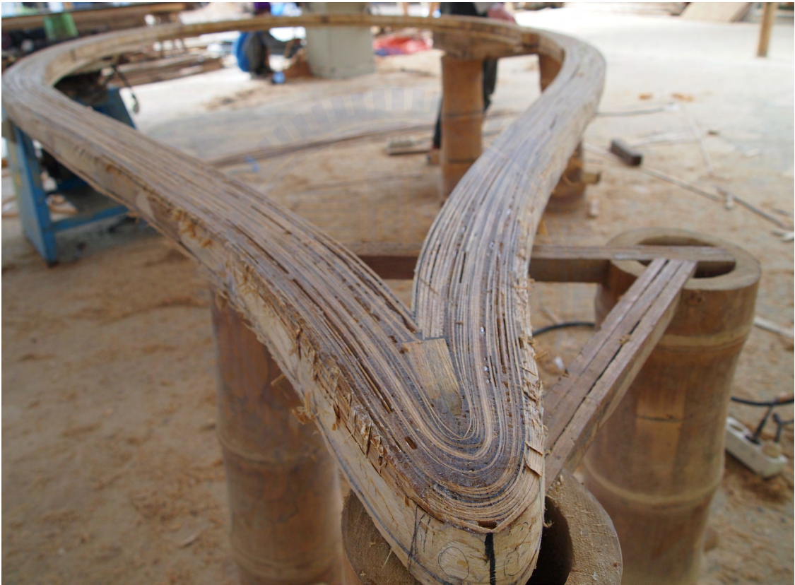
竹材製竹膠合材料做旋轉
