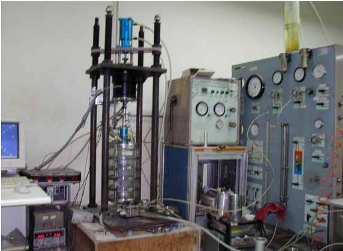
圖 3-8 中空扭剪三軸試驗設備
