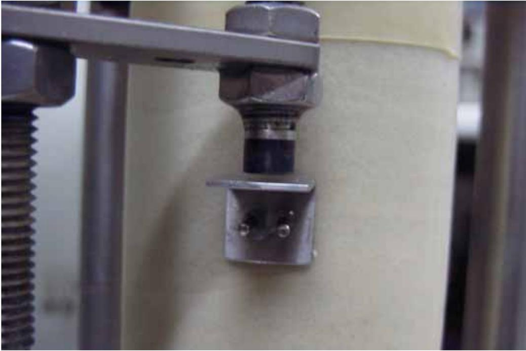
圖 2-30 微應變三軸試驗使用 proximator 設備量測試體局部應變(林靜宜, 2003)
