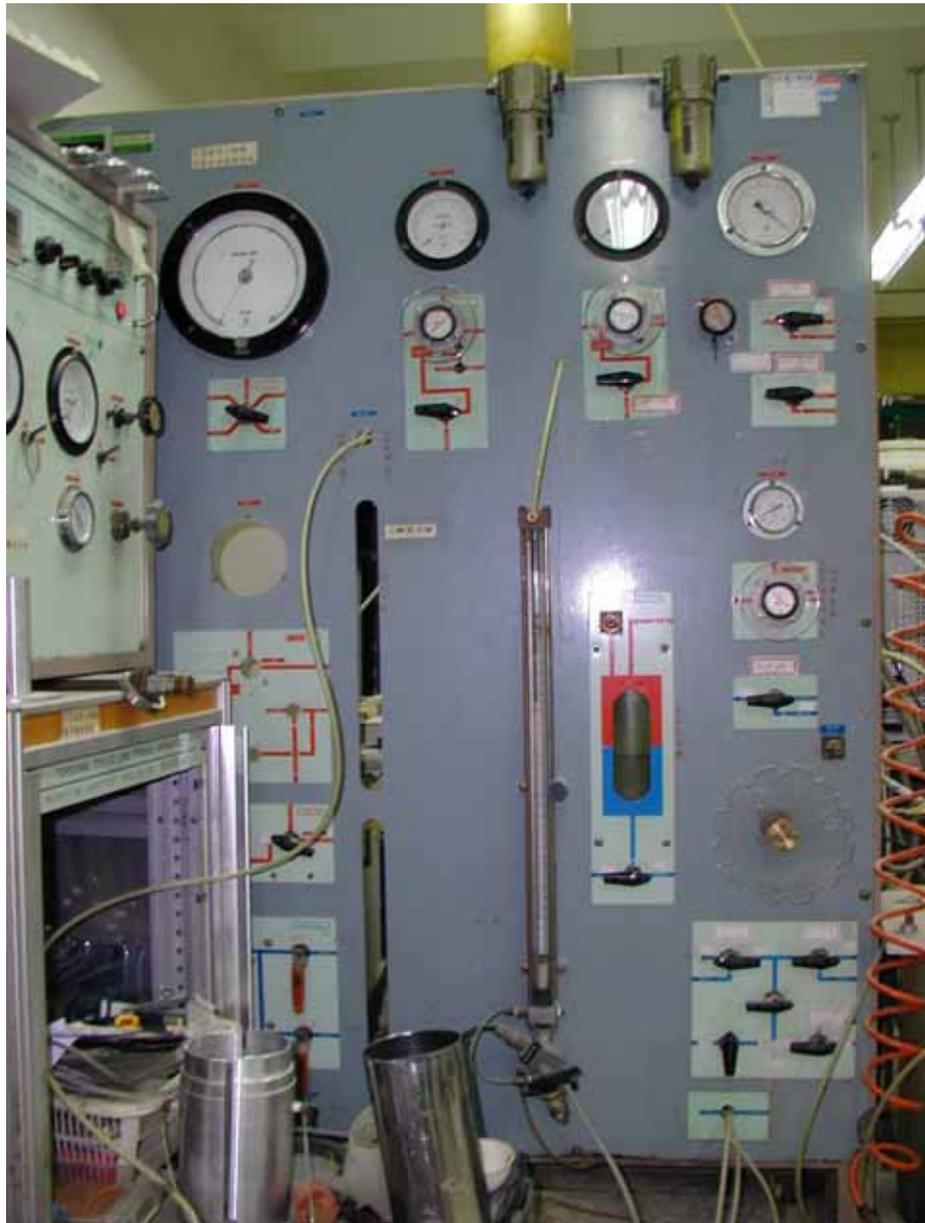
圖 3-13 氣壓與水壓控制面板
