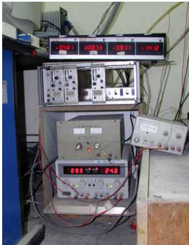
圖 3-20 訊號擷取設備—訊號放大器與電表
