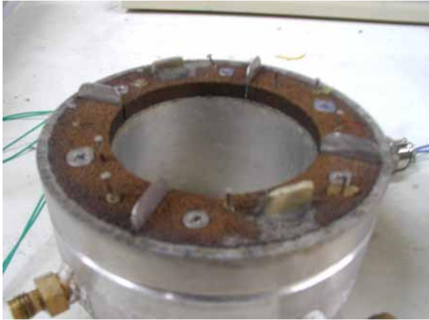
圖 3-16 試體底座接收端剪力波元件設備
