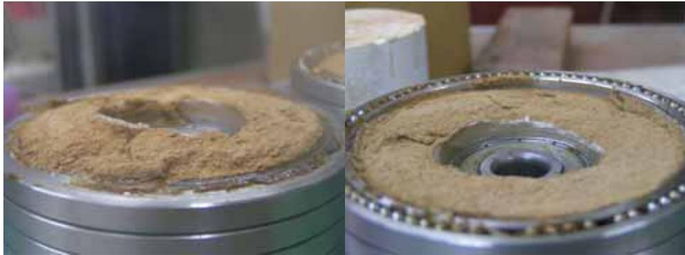
圖 5.41 四次循環試驗後水平裂縫
