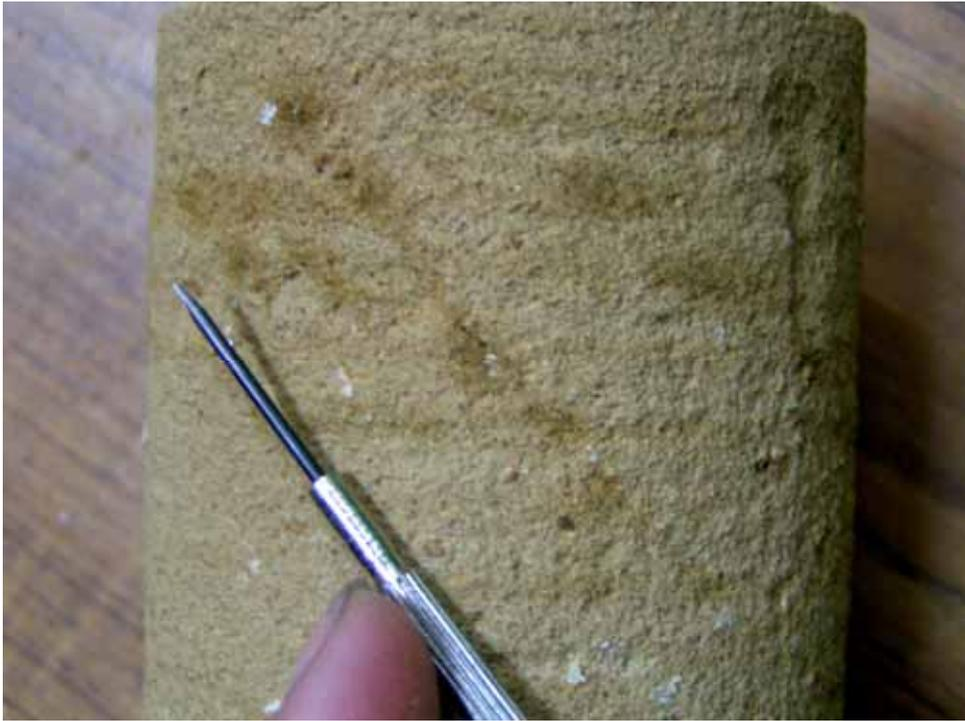
圖 5.18 約 45 度裂縫(細微)
