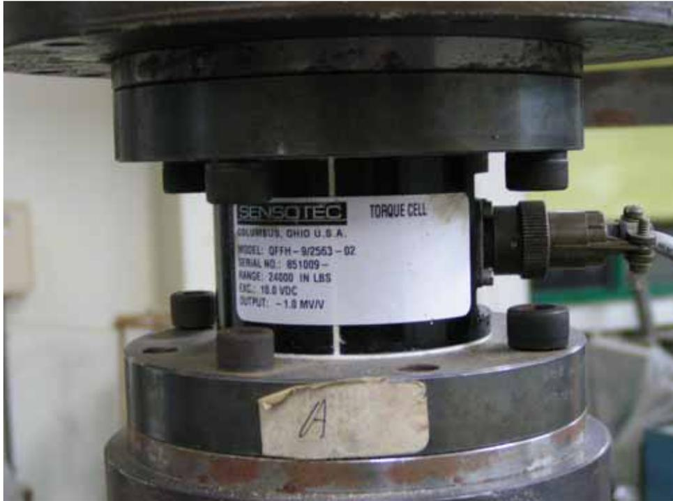
圖 3.12 SENSOTEC 製造之高承載扭力計
