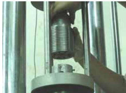
圖 3.26 下加载鈹上膠並微調油壓缸與試體接合
