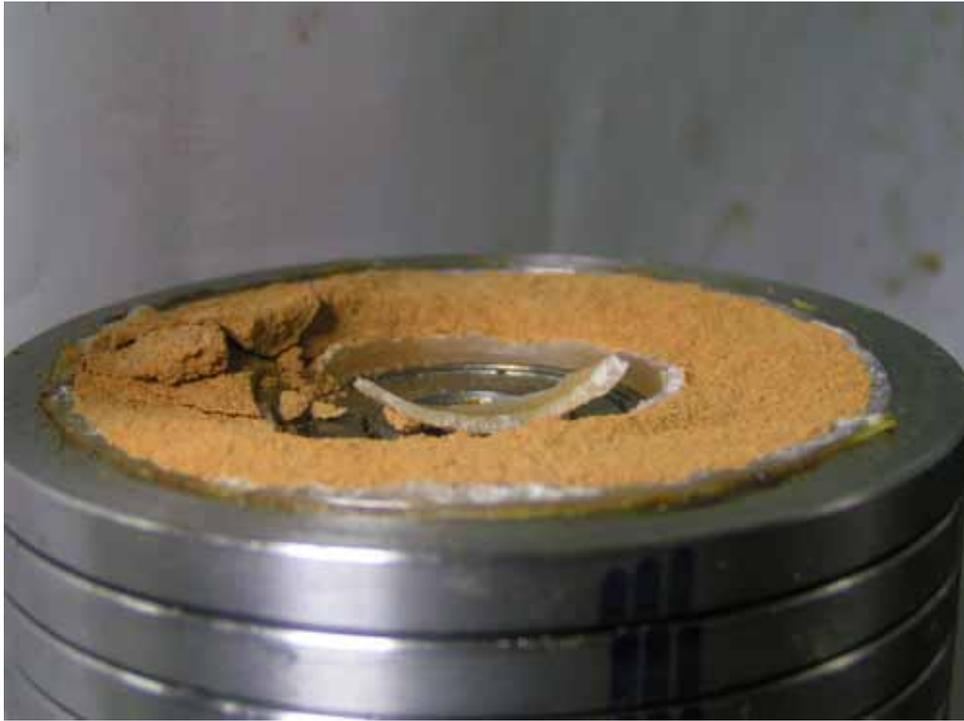
圖 5.29 固定體積環剪試驗試體之水平破壞面
