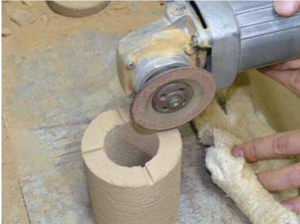
圖 3.20 以砂輪機輕劃溝槽
