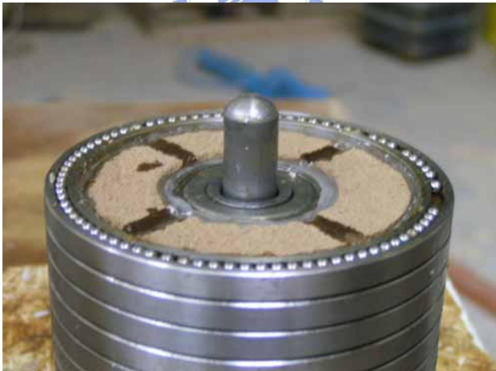
圖 3.21 試體溝槽塗膠
