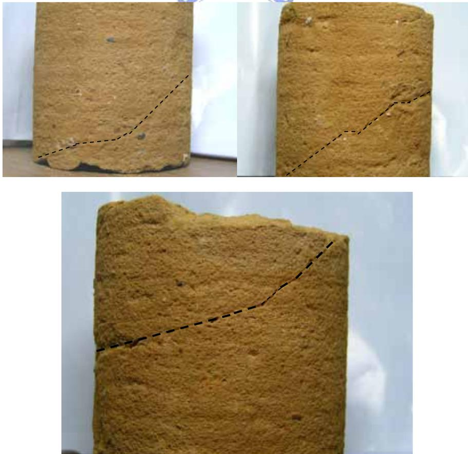
圖 5.30 固定體積裂縫發展圖(由底部向上部)
