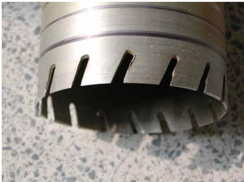
圖 3.16 筒身端部以砂輪機劃出鋸齒 (取自劉晉材, 2004)
