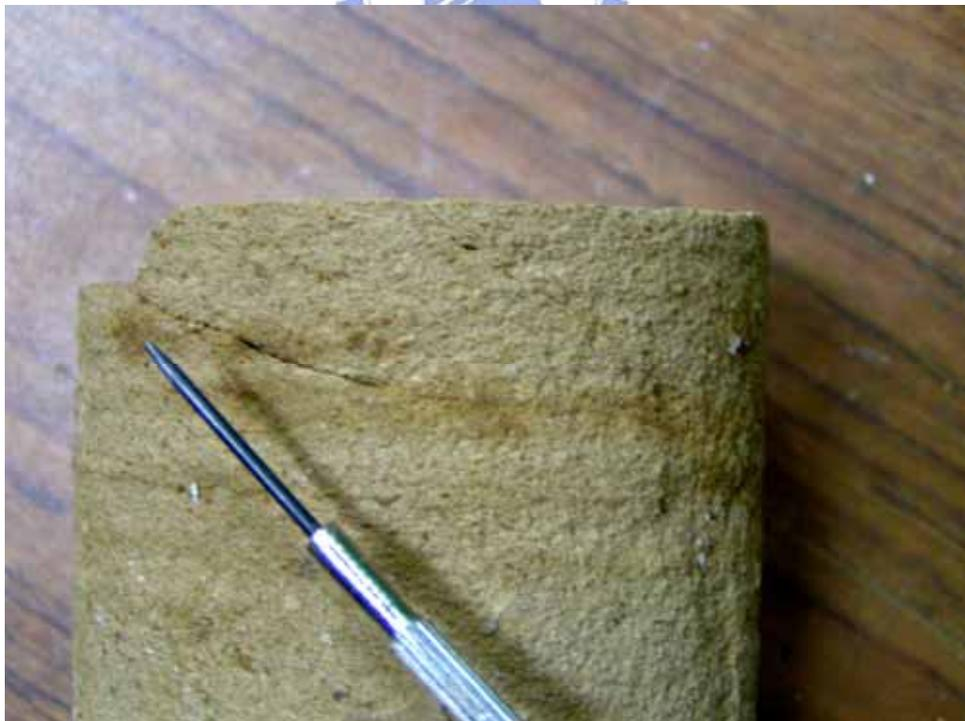
圖 5.19 接近試體上端裂縫(平緩且寬大)
