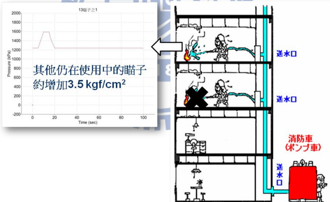
圖 64 模擬四(使用中 1 線瞄子快速關閉再開啟)示意圖
