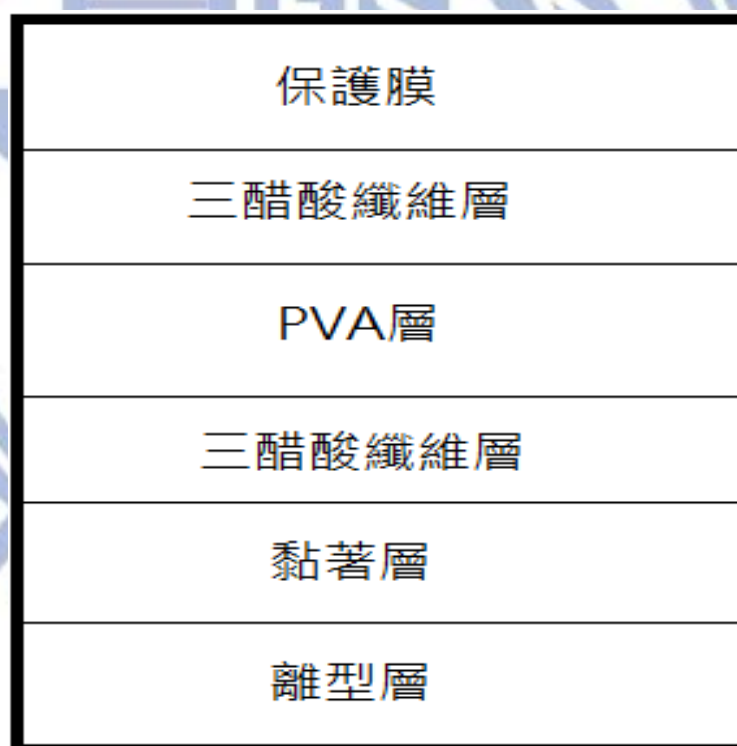
圖 2.9 偏光片結構示意圖
