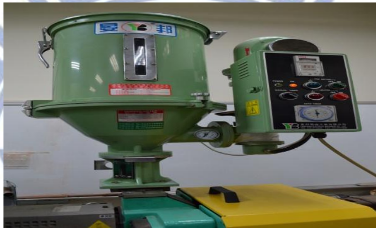
圖 3.6 塑料乾燥設備
