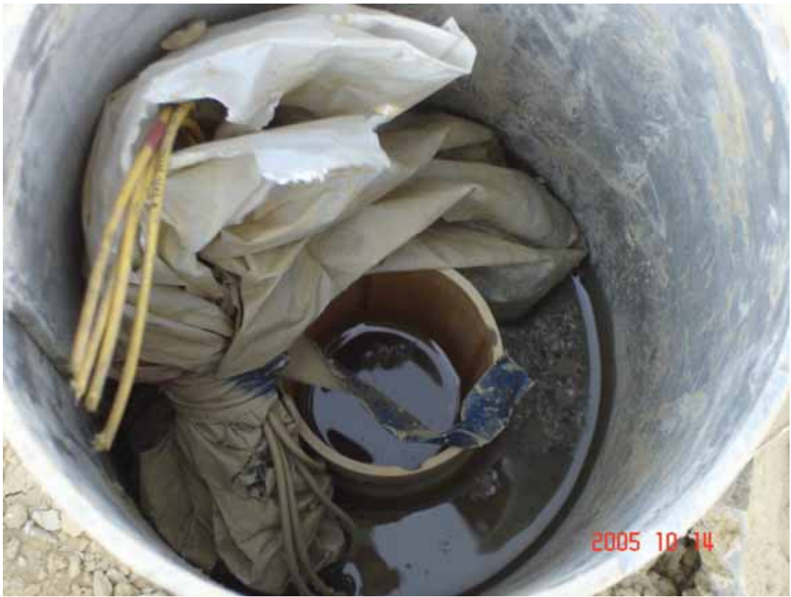
圖 5-9 測傾管內的水位
