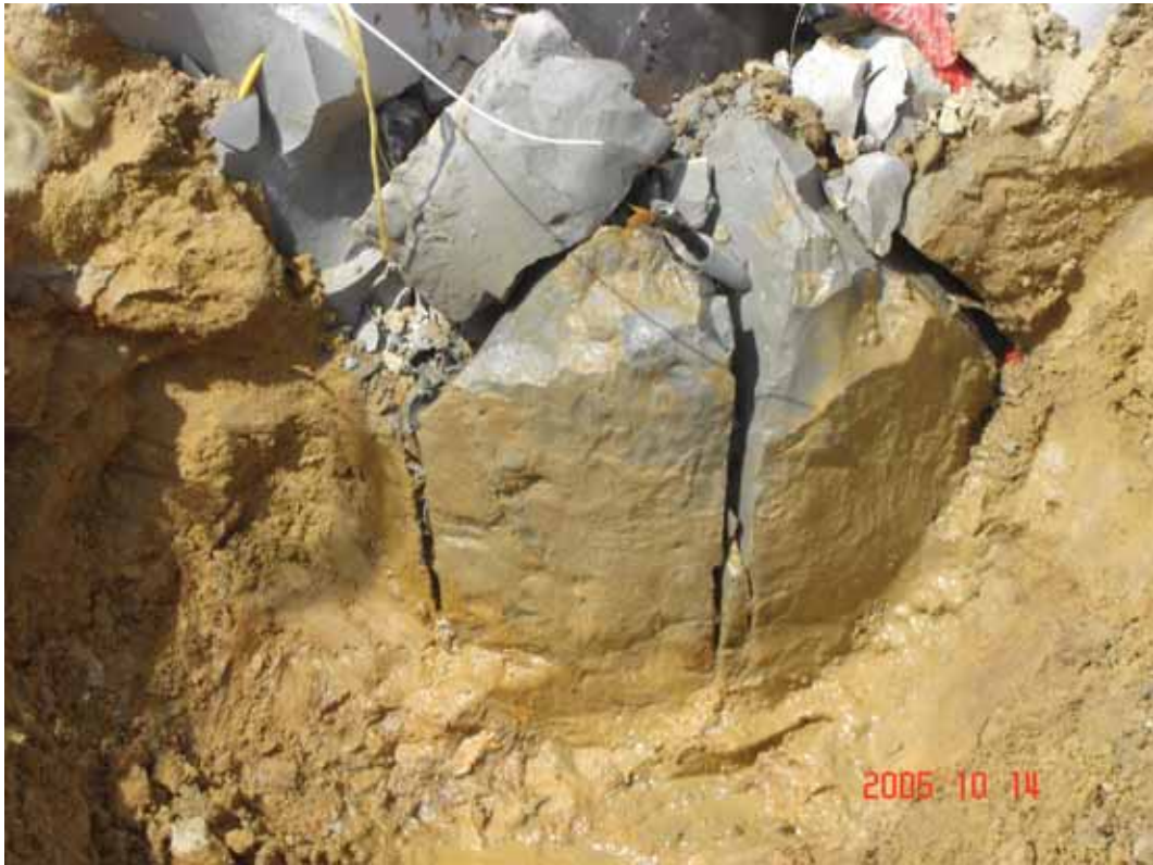
圖 5-2 現地樁載重樁身粗糙度之實體圖
