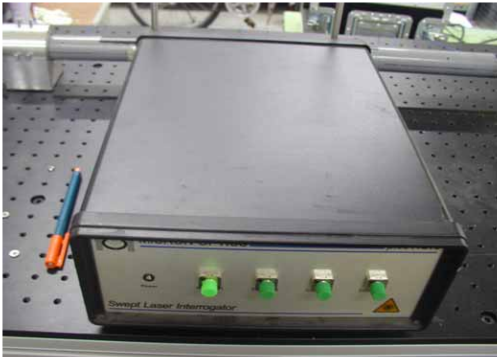
圖 3-17 光纖光柵訊號擷取系統
