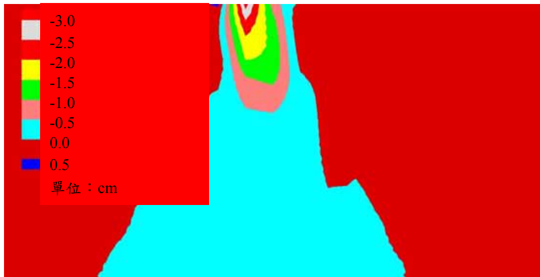
圖 4-9(a) 試驗樁中心至底部邊界距離=15 倍樁徑時垂直方向位移量模擬之結果
