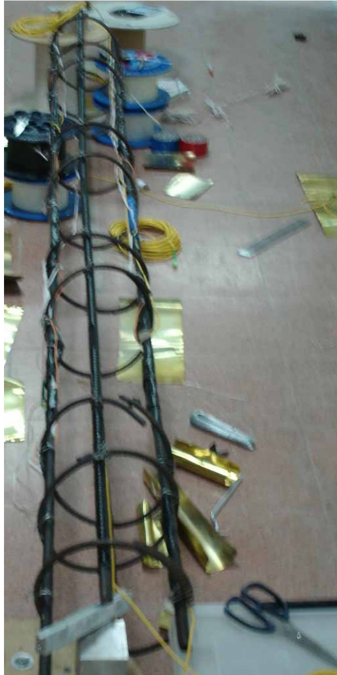
圖 3-6 (c) 樁體之鋼筋籠準備完成後之實體圖
