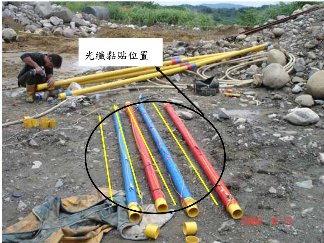
圖 3- 16 (b) 光纖直接黏貼於測傾管上之實體圖
