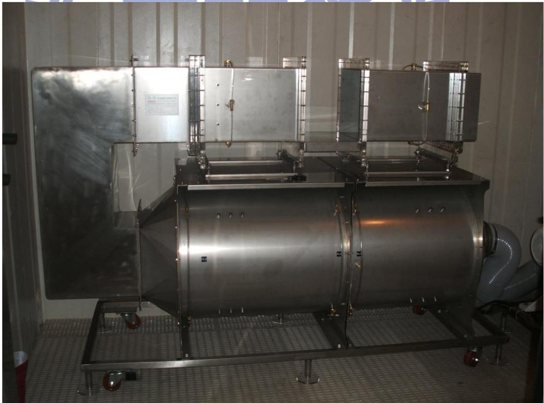
圖 3-2 實際風洞設備照片
