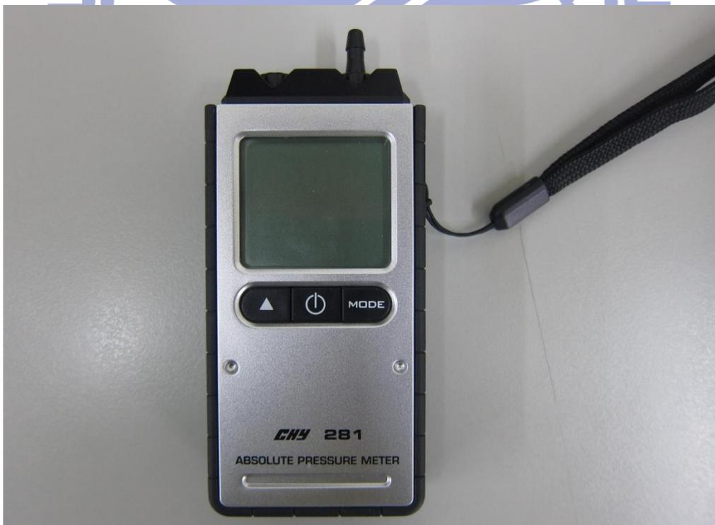
圖 3-6 大氣壓力計(絕對壓力)
