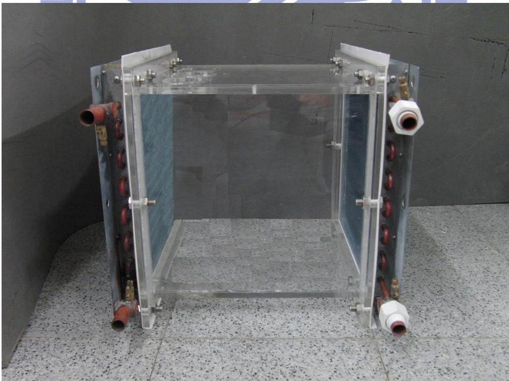
圖 3-8 旁通裝置壓克力板件
