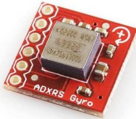
圖四十九、陀螺儀 ADXRS613 之外觀圖（來源：[58]）
