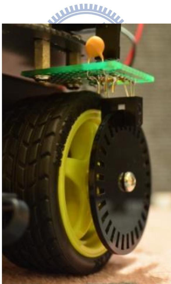
圖三十八、本研究所使用之自製光學編碼器
