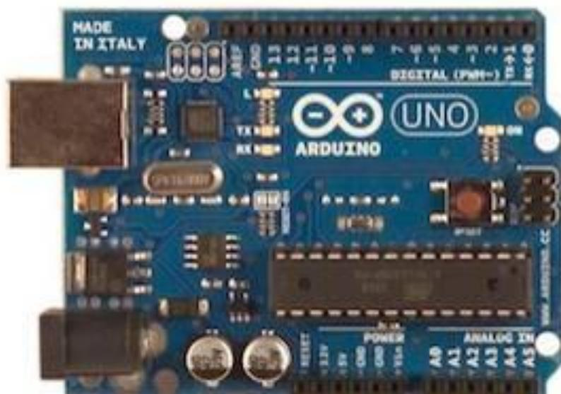
圖三十七、Arduino UNO 控制板(來源：[51])
