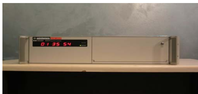
圖4-10 TWTF站所使用的銫原子鐘
