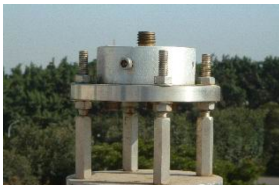
圖3-1 強制定心樁的定平機制
