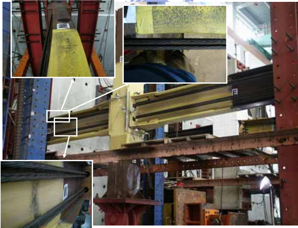
照片 4.16 試體 S2-2 於 5.0% 第二圈時梁挫屈情形
