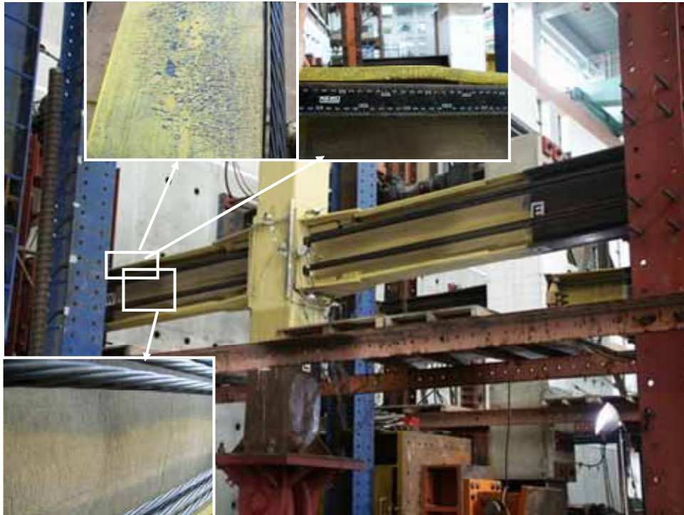
照片 4.15 試體 S2-2 於 5.0% 第一圈時梁挫屈情形
