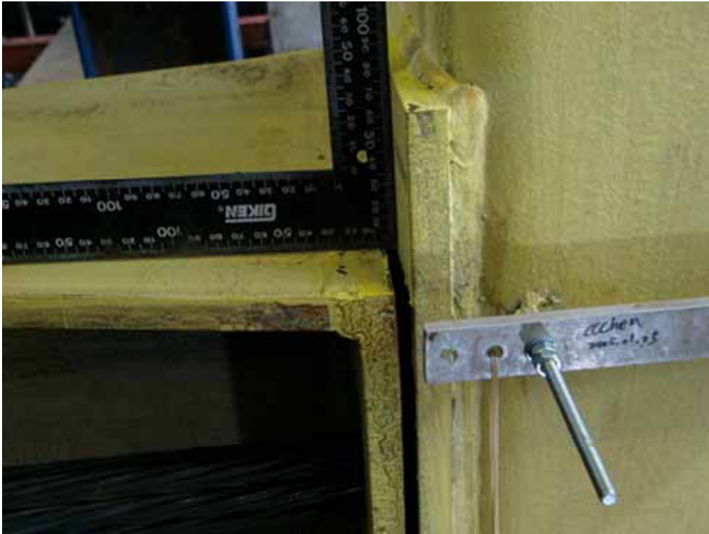
照片 4.17 試體 S2-2 於試驗結束後殘餘變形
