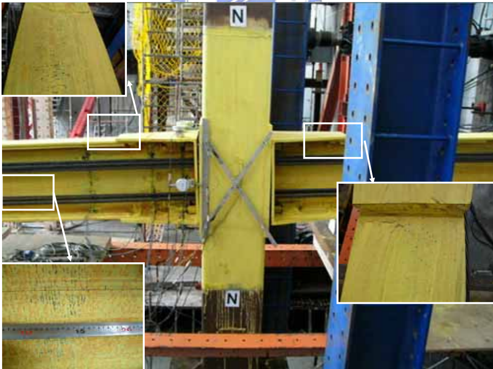
照片 4.12 試體 S2-1 於 4.0% 時梁腹板上應力集中情形
