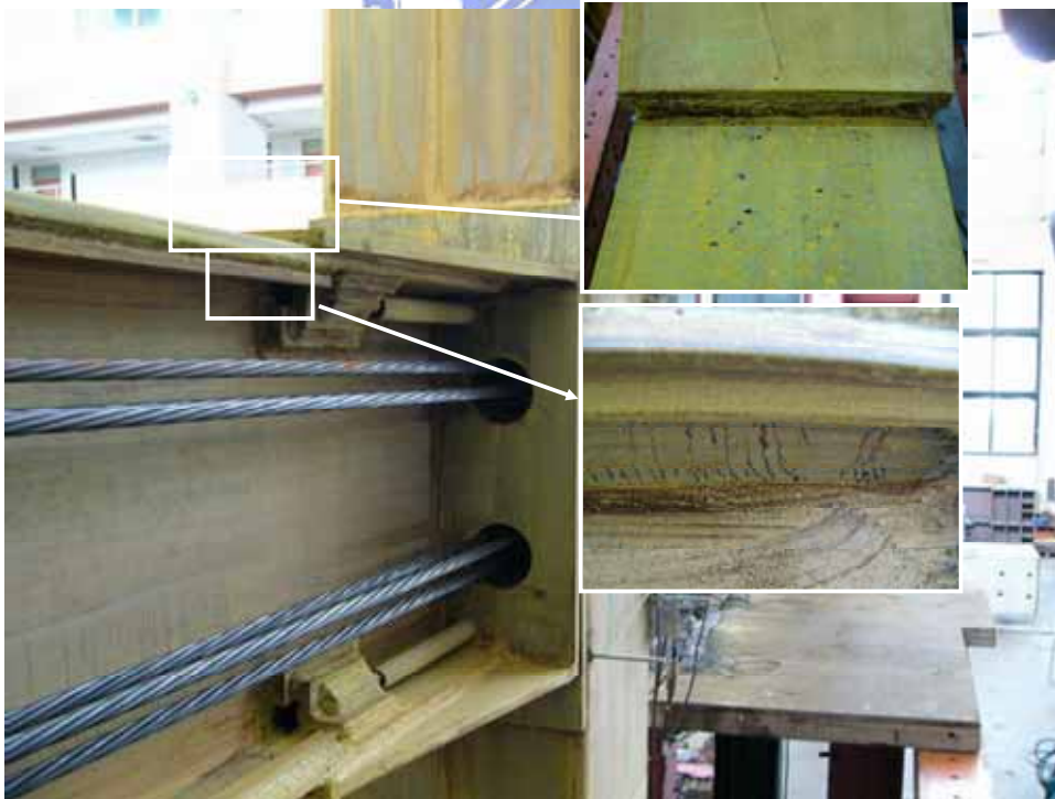
照片 4.4 試體 S1-2 於 3.0% 時蓋板末端試體受力情形
