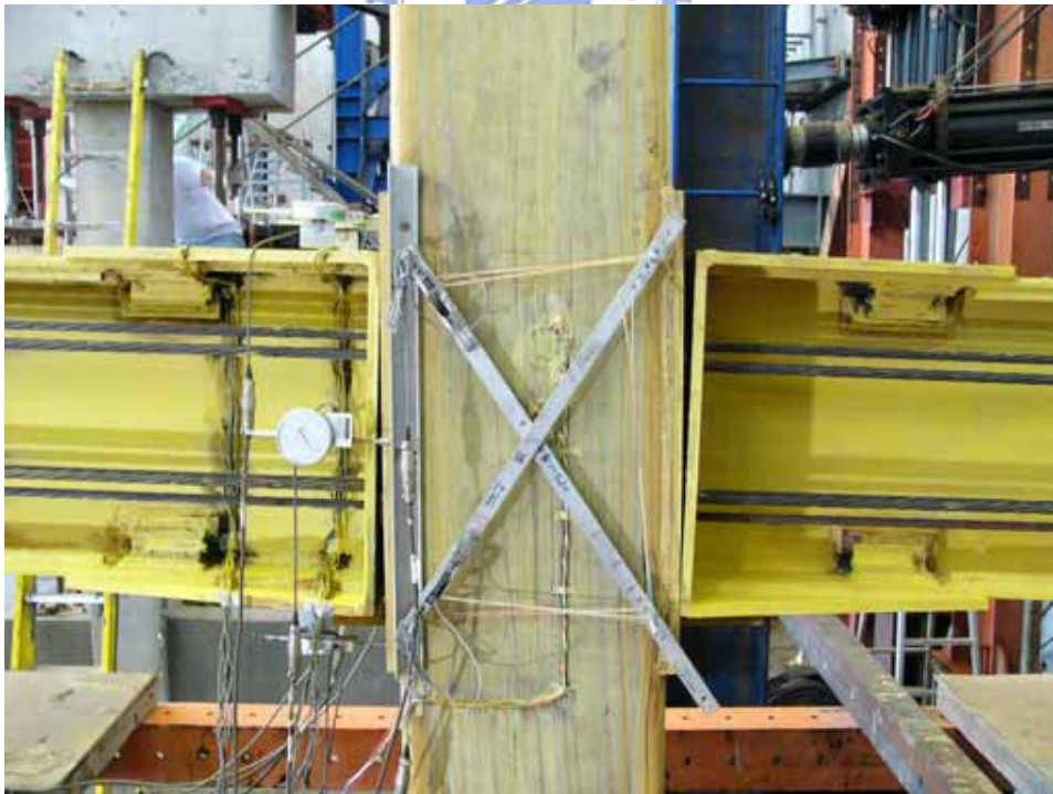
照片 4.2 試體 S1-1 於 4.0%柱接合面的縫隙
