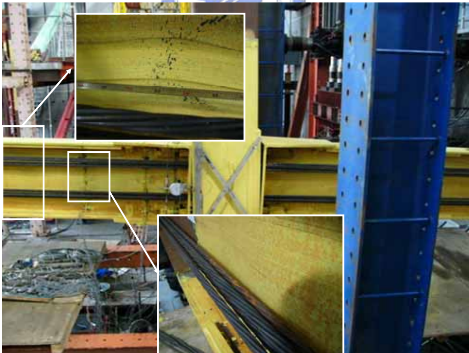
照片 4.14 試體 S2-1 於 5.0% 第二圈時梁挫屈情形
