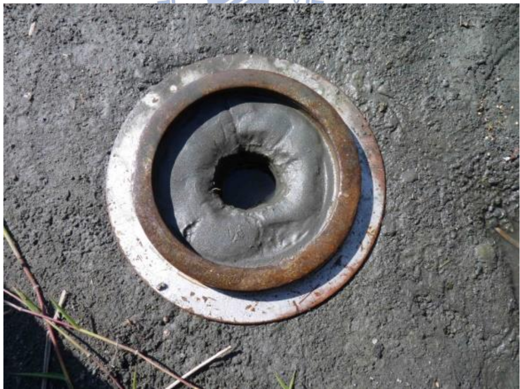
圖 3-2 Mini Jet 土壤沖蝕之沖蝕坑
