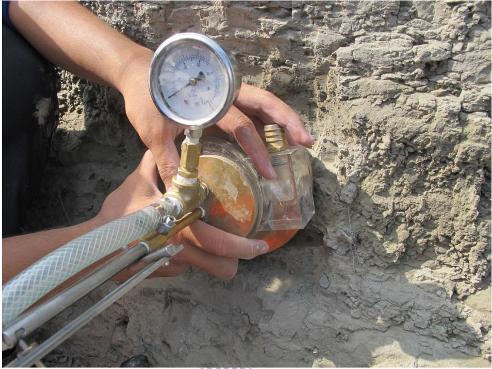
圖 5-19 大安溪現地側壁沖蝕試驗
