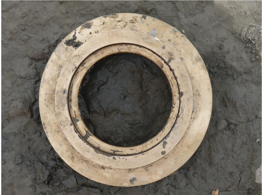
圖 3-3 Mini Jet 軟岩沖蝕之沖蝕坑
