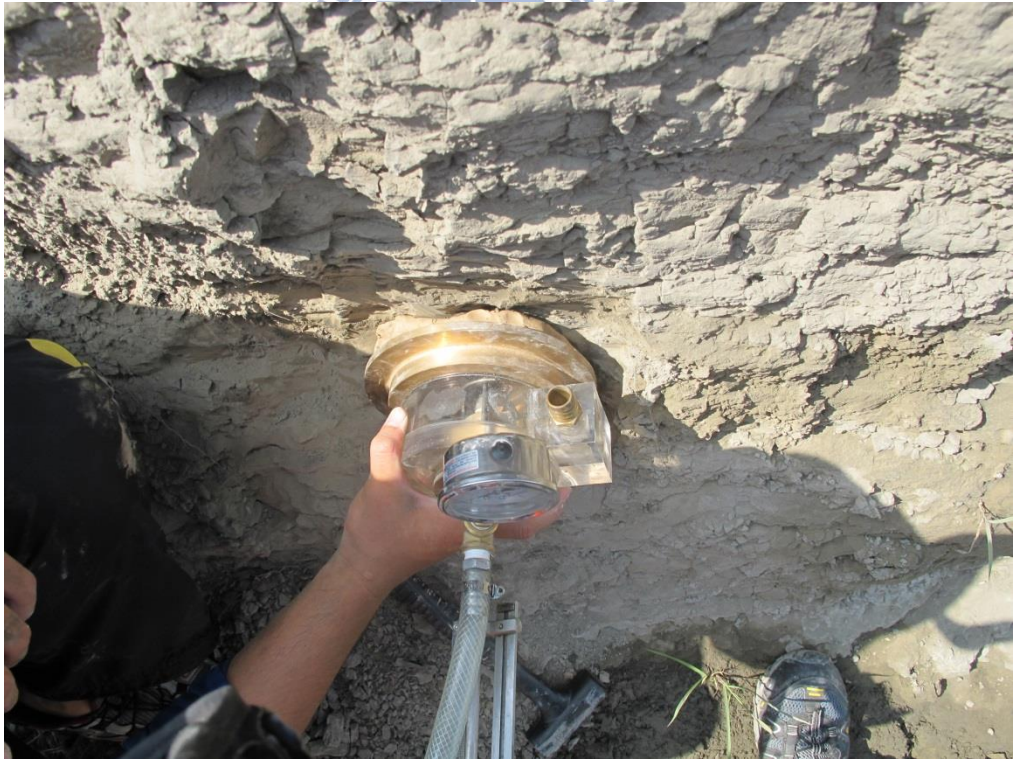
圖 5-20 大安溪現地側壁沖蝕試驗
