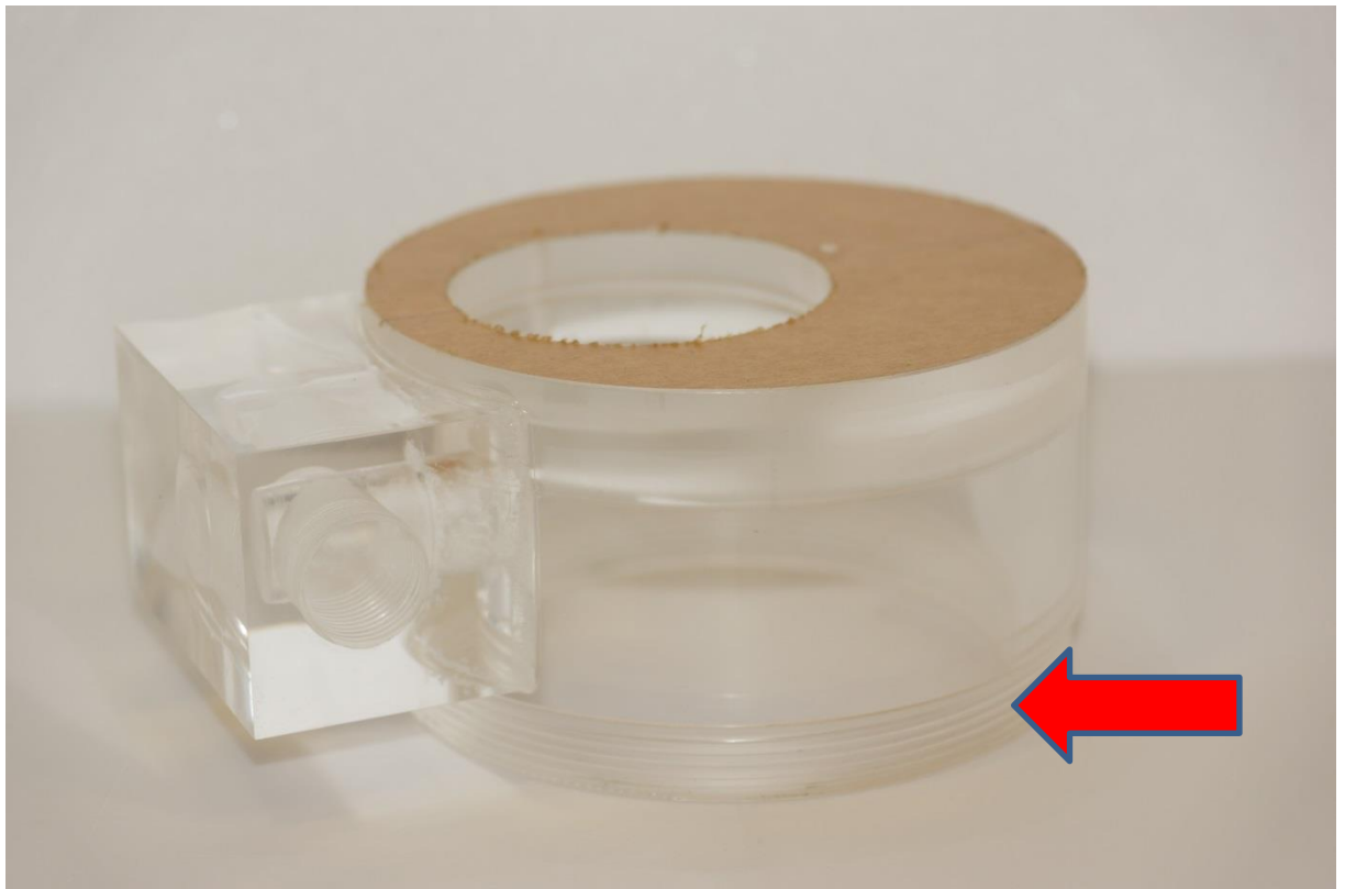
圖 3-31 (7)壓克力盒成品側視(箭頭指向處為螺牙)
