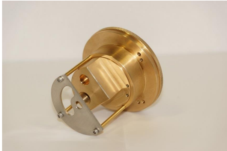
圖 3-24 (3)可轉部、(4)固定部及(5)弧形環片成品組合
