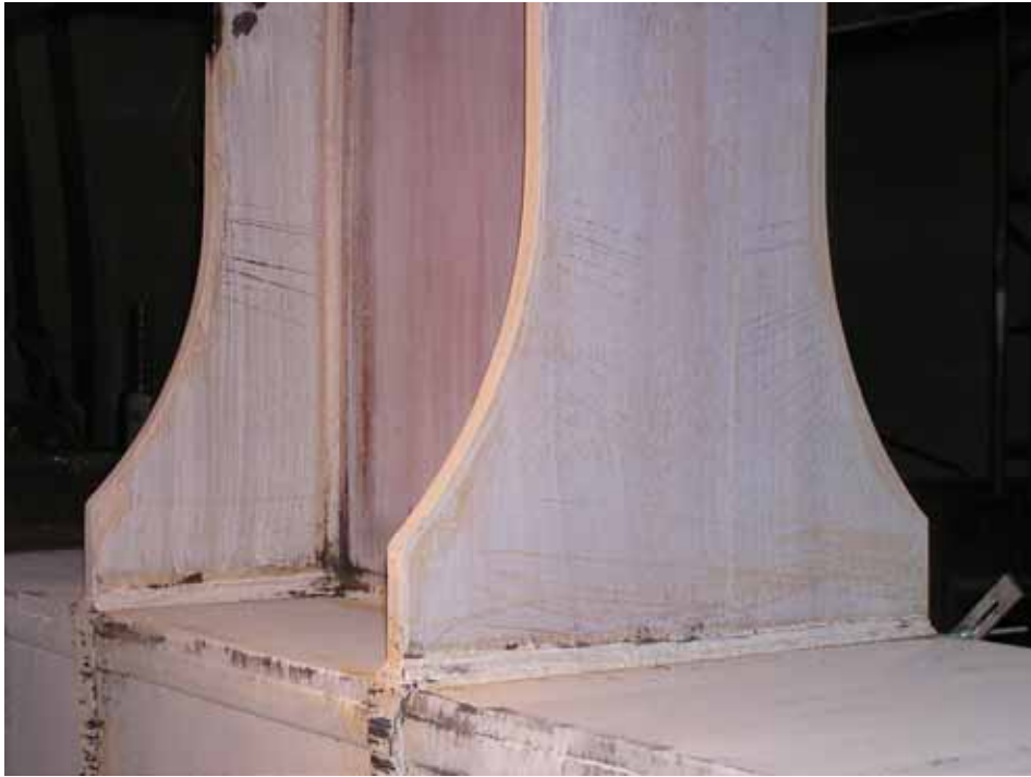
照片 4.19 試體 W10-L2 於擴翼板圓弧段呈現微量石灰剝落 (1% drift)
