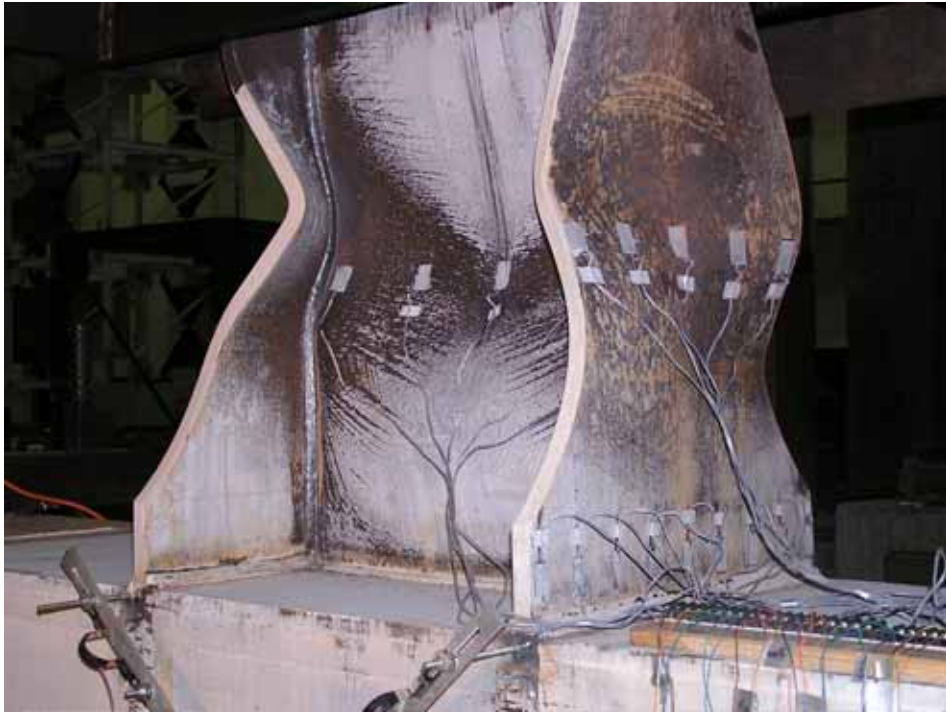
照片 4.25 試體 W10-L2 於梁翼板及腹板嚴重挫屈 (5.8% drift)
