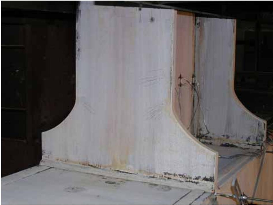
照片 4.3 試體 W10-L1 於下擴翼板圓弧段末端處呈現初始石灰脫落 (0.75% drift)
