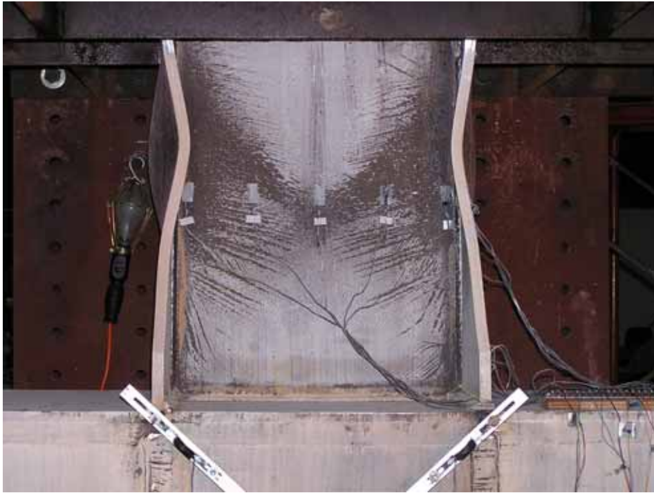
照片 4.23 試體 W10-L2 於梁翼板局部挫屈及塑鉸形成 (4% drift)
