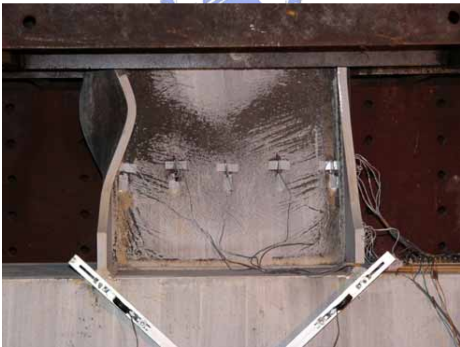
照片 4.8 試體 W10-L1 梁下翼板局部挫屈及塑鉸形成 (4% drift)
