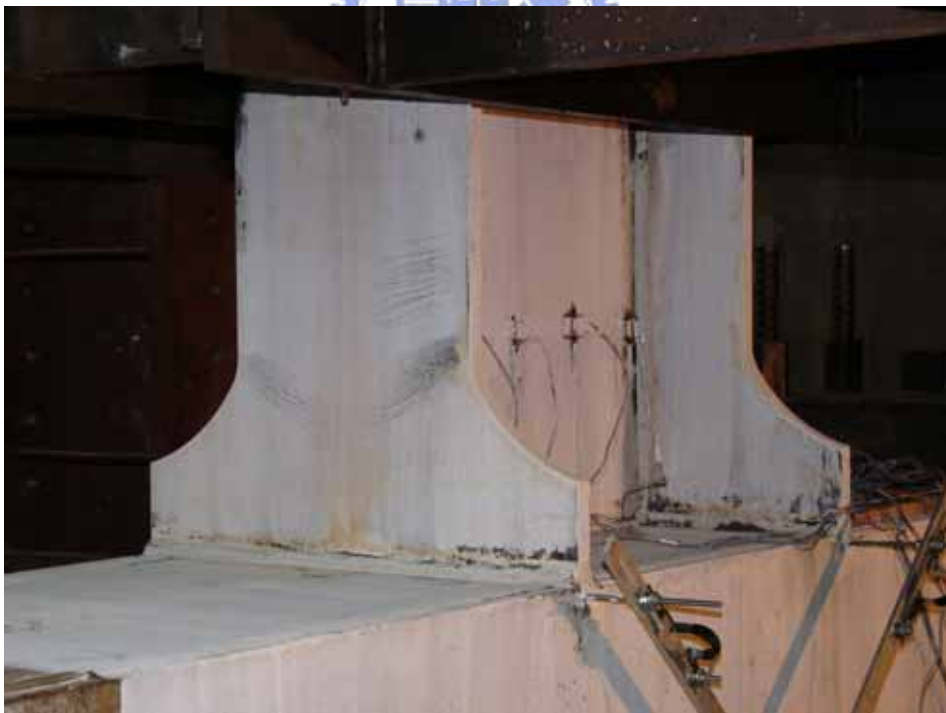
照片 4.3 試體 W10-L1 於下擴翼板圓弧段末端處呈現初始石灰脫落 (0.75% drift)
