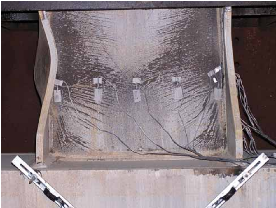
照片 4.15 試體 W08-L1 梁下翼板局部挫屈及塑鉸形成 (4% drift)
