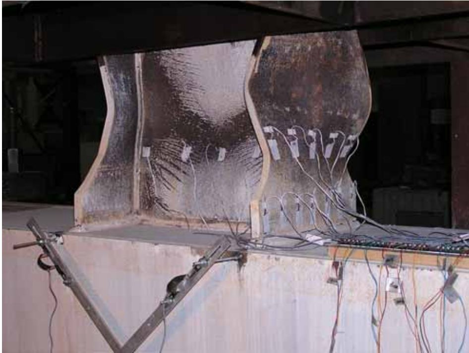
照片 4.17 試體 W08-L1 梁翼板嚴重挫屈 (5.7% drift)
