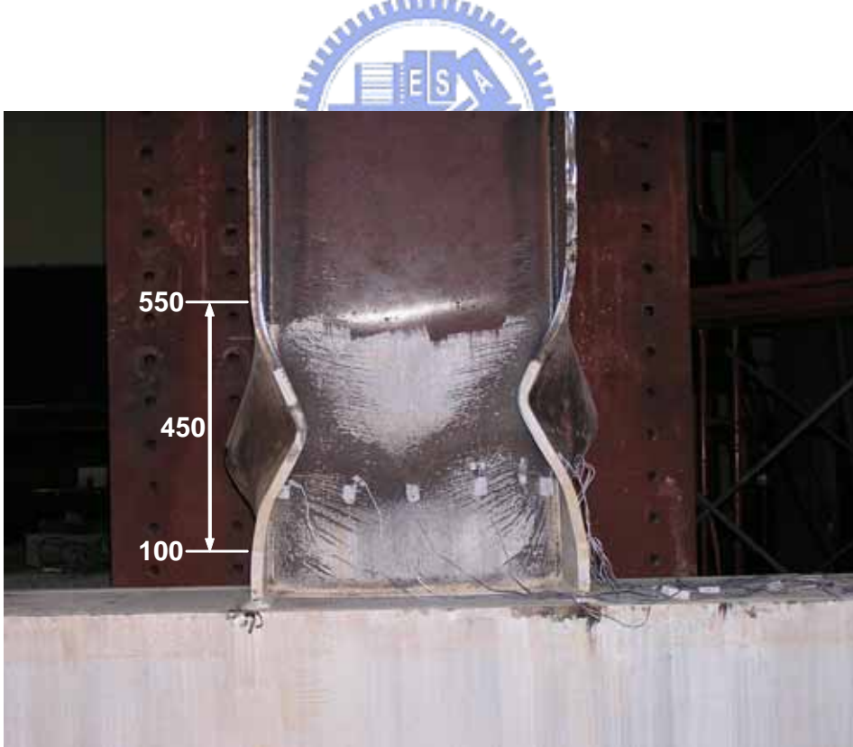
照片 4.17 試體 W08-L1 梁翼板嚴重挫屈 (5.7% drift)
