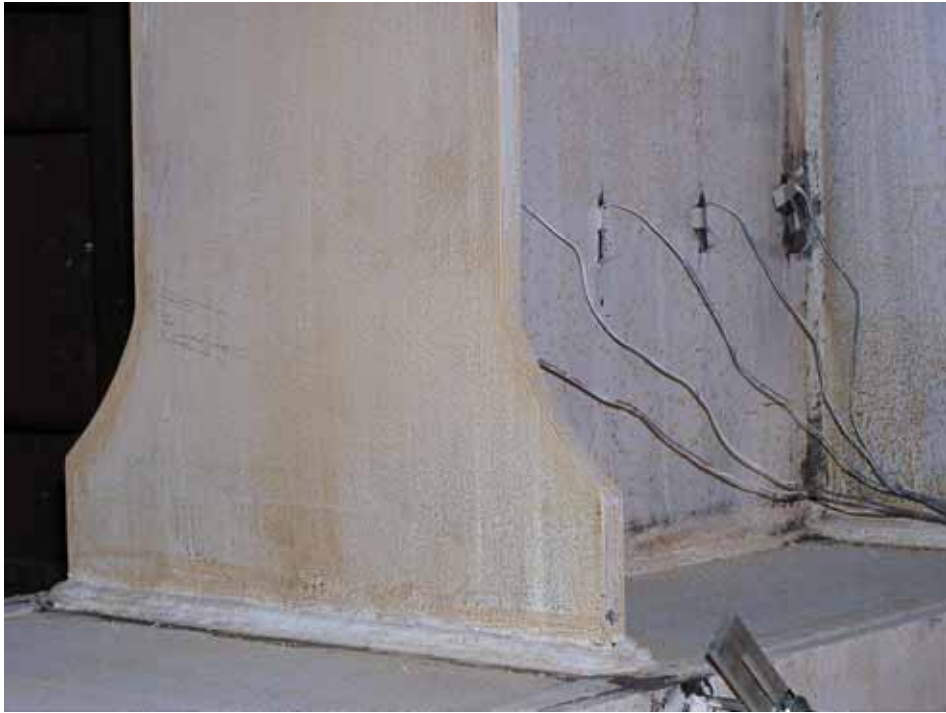
照片 4.11 試體 W08-L1 下擴翼板圓弧段末端處呈現微量石灰剝落 (1% drift)
