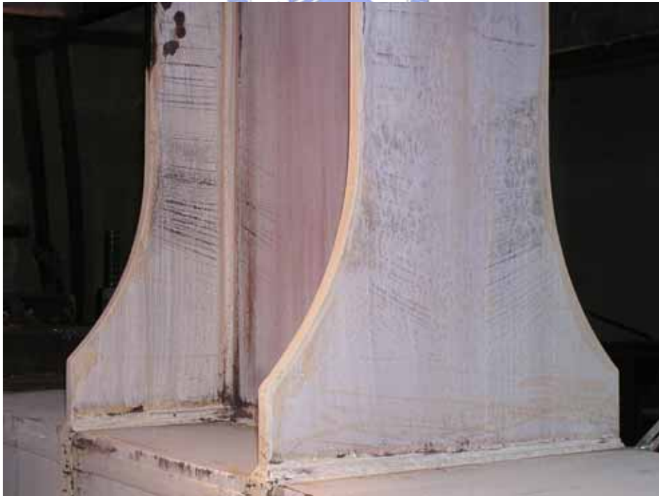
照片 4.20 試體 W10-L2 於梁腹兩側呈現斜向斑紋 (1.5% drift)
