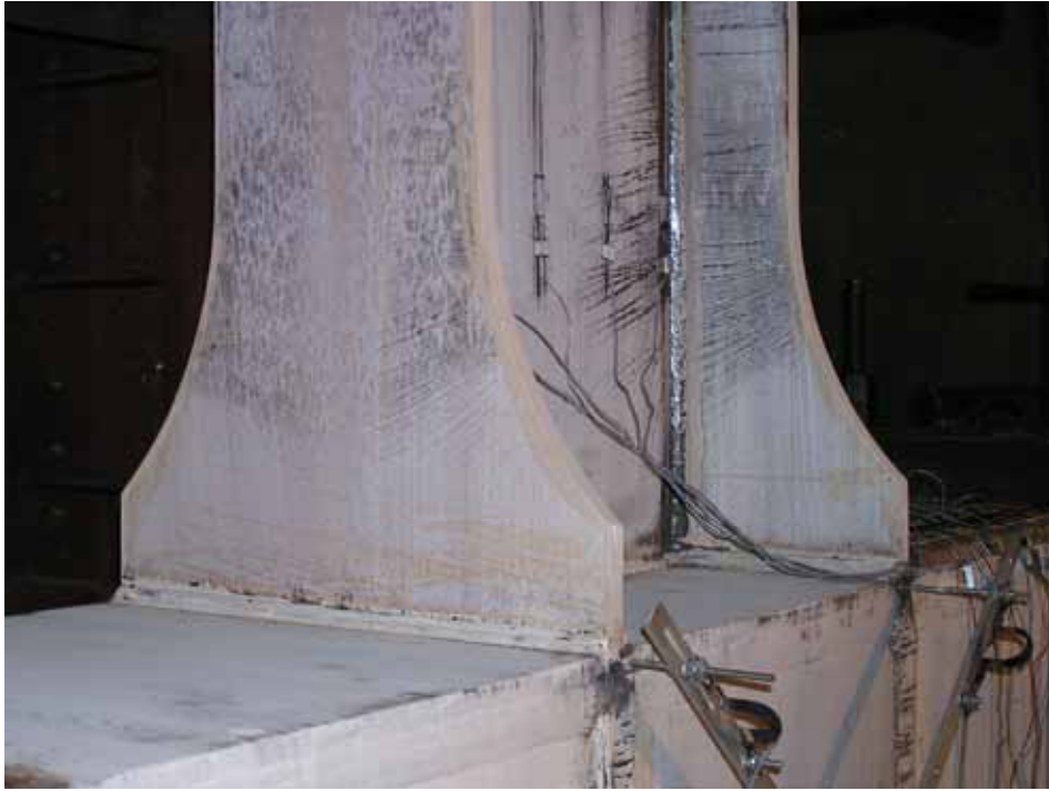
照片 4.21 試體 W10-L2 於梁腹兩側斜向斑紋持續增加 (2% drift)
