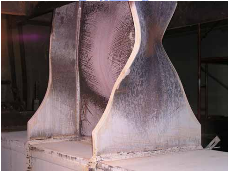
照片 4.24 試體 W10-L2 於梁翼板及腹板嚴重挫屈 (5% drift)
