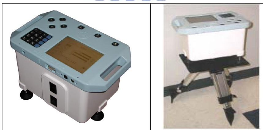
圖2-8 Graviton-EG 相對重力儀外觀及三腳架的配置圖(魏祥鴻，2005)
