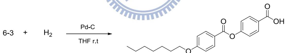
將化合物 6-3 (10g, 22 mmol) 置於 500 mL 雙頸瓶內, 以 300 mL 的 THF 溶解, 加入 10% wt Pd-C (1 g) 催化劑, 攪拌均勻, 在氮氣系統下, 反應 16 小時。以 TLC 片點片確認反應。以 Celite 過濾 Pd-C 再以 THF 洗滌, 濃縮乾燥。最後運用 Hexane/DCM 再結晶, 過濾烘乾得白色固體, 產率 95%。
