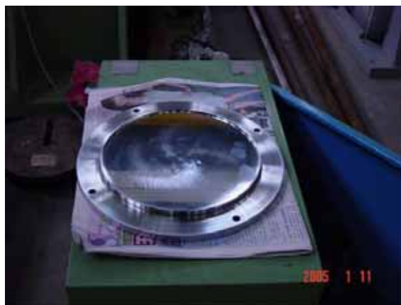
圖 4.5 摩擦單擺支承凹面板
