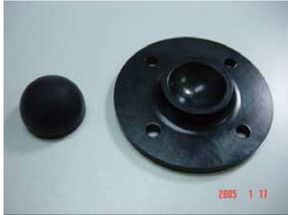
圖 4.6 披覆鐵弗龍材料的摩擦子及基座
