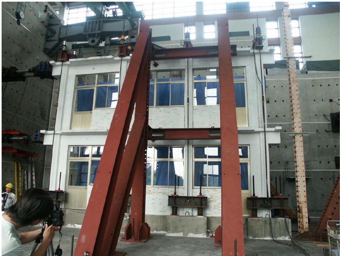
圖 2.9：SBFU 試體之側向支撐配置圖
