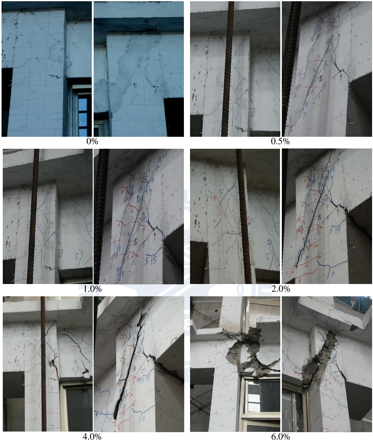
圖 2.17：SBFU-C 試體之外柱接頭破壞發展(左為 J11，右為 J14)
