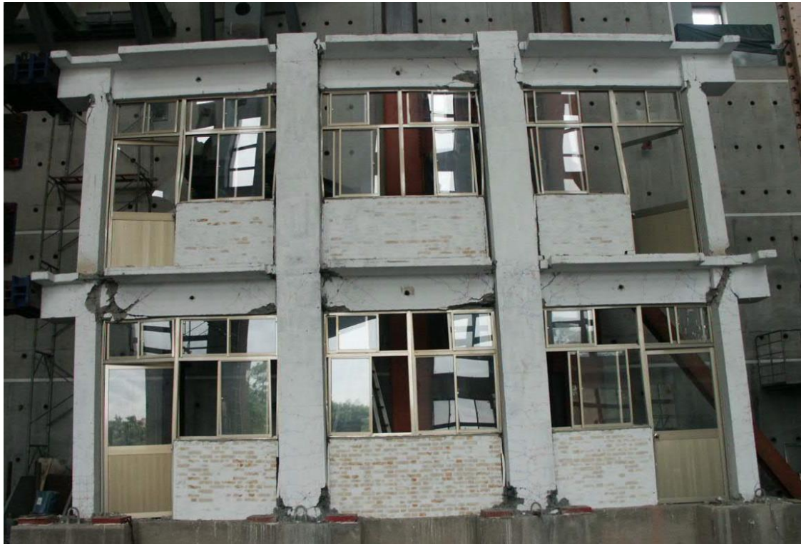
圖 2.18：SBFU-C 試體最終破壞模式
