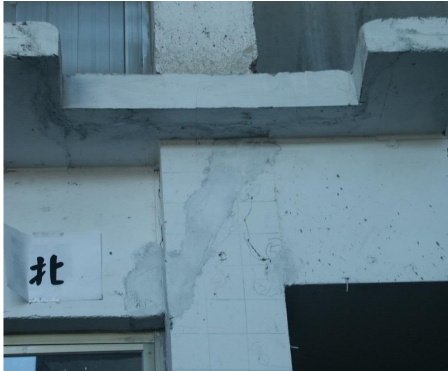
圖 2.12：SBFU-C 試體 C14 接頭試驗前照片
