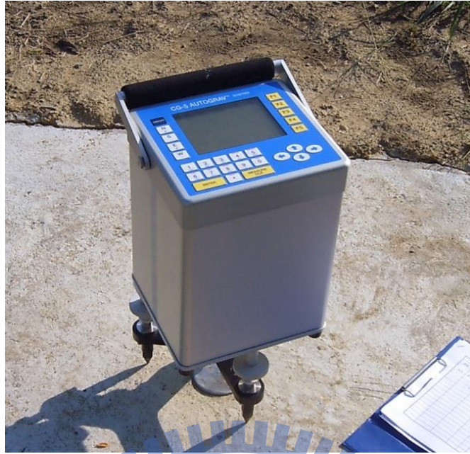
圖 2-14：Scintrex CG-5 重力儀
