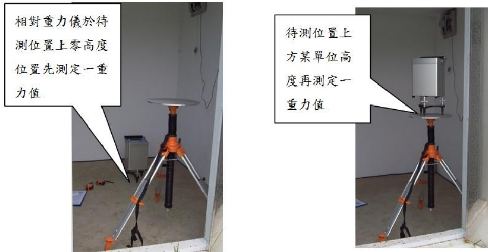
圖 2-3：簡易重力梯度值測量方法(左：零高度測定重力值，右：單位高度測定重力值)
