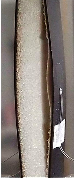
圖 3.27 含 50 mm 脫層之 [(0/90)_2]_s 三明治試片破壞情形[20]
