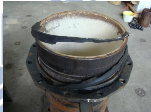
(b) 試驗結束直管接頭無損壞
