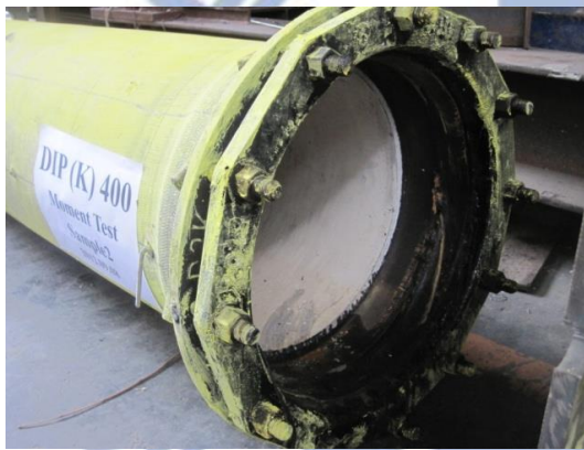
(a) 承口試驗下緣膠圈破壞情形 (b) 插口內襯水泥剝落
