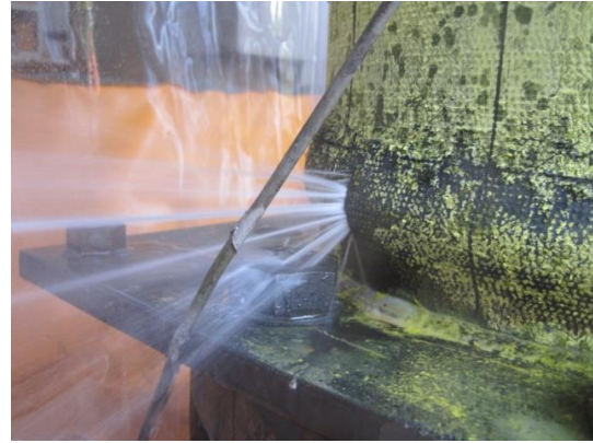
(b) 插口段挫屈漏水
