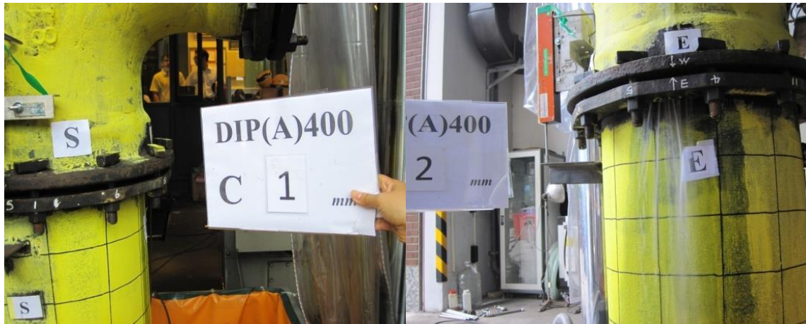
圖 3.37 DIP(A)400-C2 試驗中情形於 1mm 東側水微漏[34]
