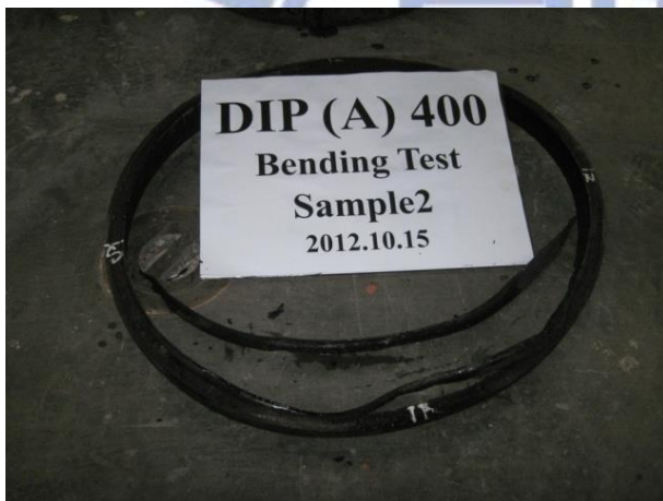
(a) 承口試驗下緣膠圈破壞情形
