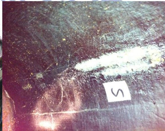
(b) A 型接頭管內裂縫形成
