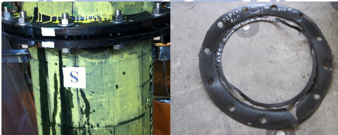
圖 3.55 DIP(F)400-C1 試驗終止情形[34] 圖 3.56 DIP(F)400-C1 試驗膠圈檢視[34]
