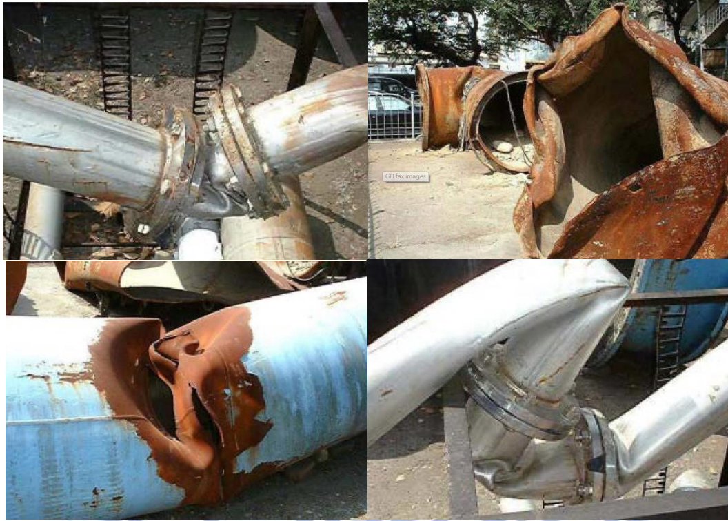
圖 1.1 自來水管線局部錯屈[6]
