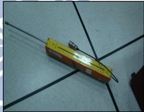
圖 2.34 LVDT 位移轉換器
