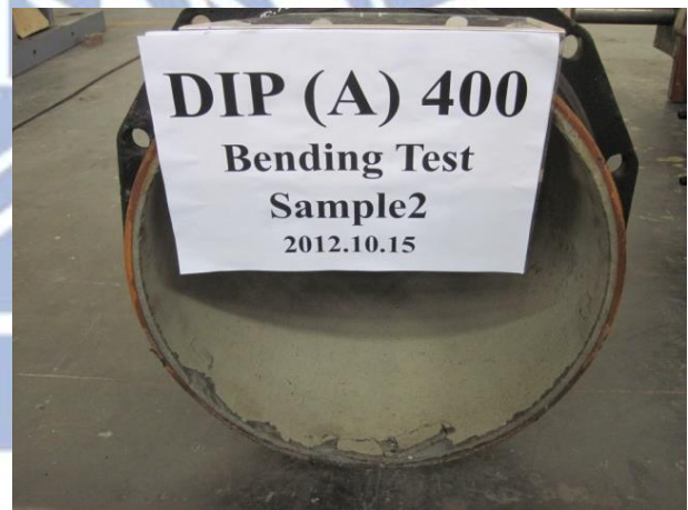
(b) 插口內襯水泥剝落
