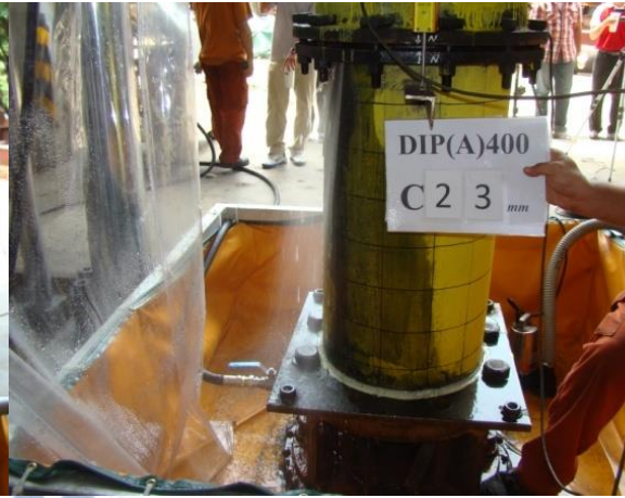
圖 3.34 DIP(A)400-C1 試驗終止情形於 23mm 東北側噴水水壓無法控制[34]
