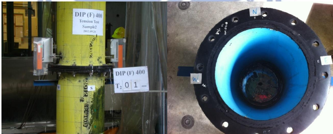
圖 3.52 DIP(F)400-T2 試驗終止情形[34] 圖 3.53 DIP(F)400-T2 試驗膠圈檢視[34]
