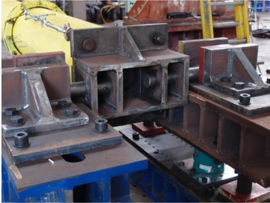
圖 2.41 試體安裝於鉸支承之情形
