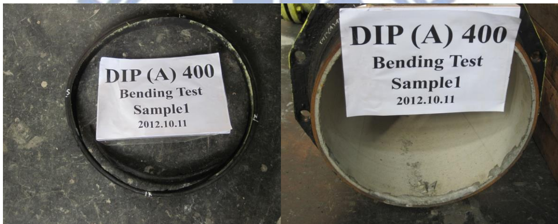
(a) 承口試驗下緣膠圈破壞情形
