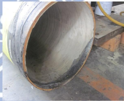
(a) 承口試驗下緣膠圈破壞情形 (b) 插口內襯水泥剝落
