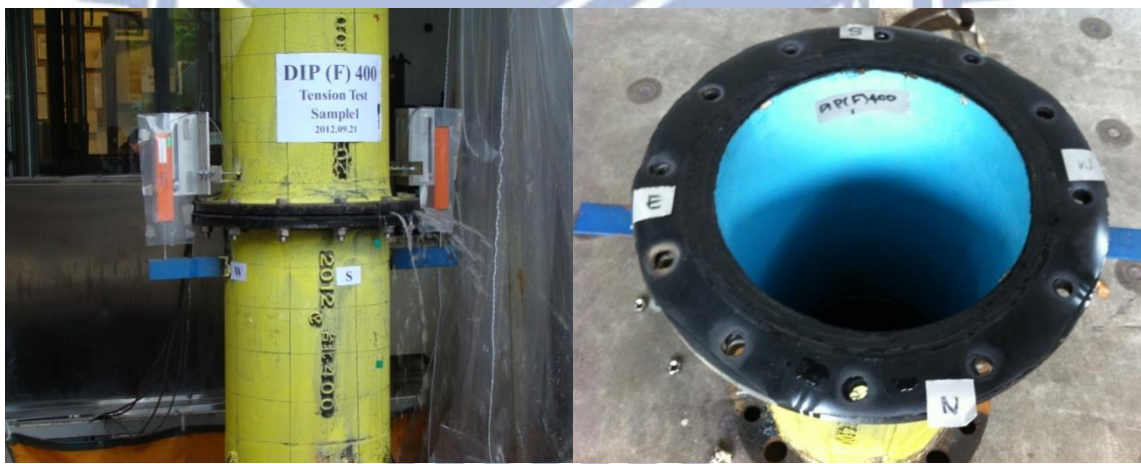
圖 3.49 DIP(F)400-T1 試驗終止情形[34] 圖 3.50 DIP(F)400-T1 試驗膠圈檢視[34]
