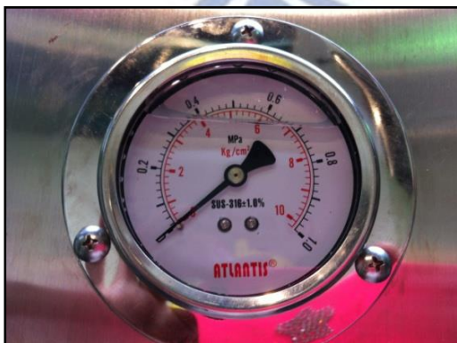
圖 2.35 水壓控制系統水壓錶(左：指針式水壓錶；右：數位式水壓錶)
