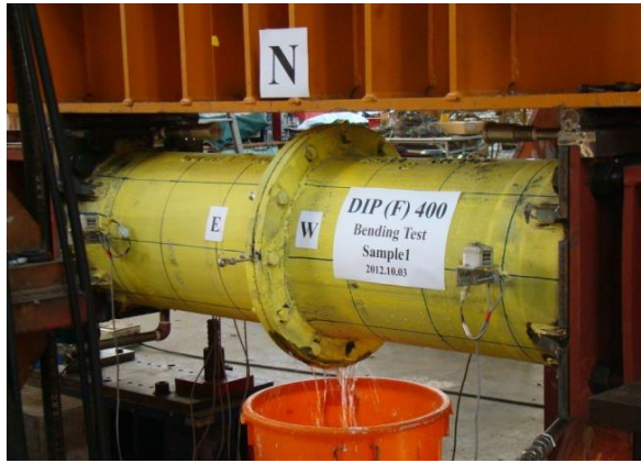
圖 3.62 DIP(F)400-B1 試驗終止情形[34]
