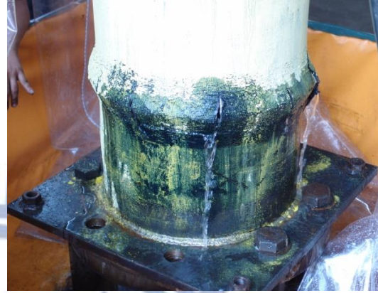
(b) 插口段挫屈漏水
