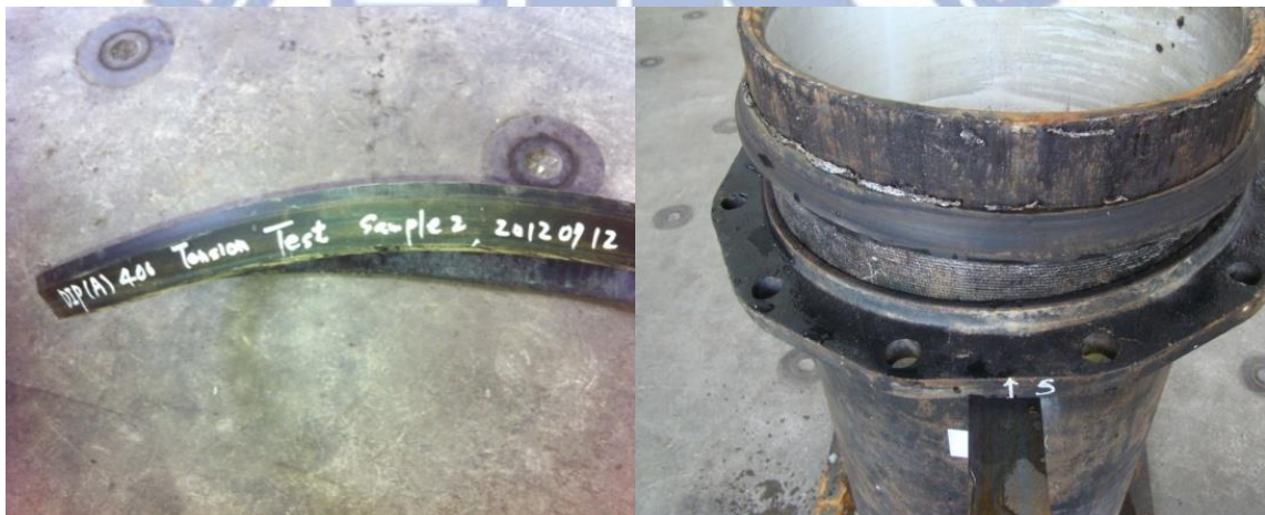
(a) 試驗結束膠圈無破壞
