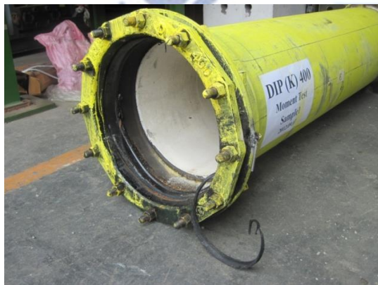
(a) 承口試驗下緣膠圈破壞情形
