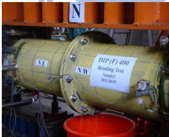
圖 3.66 DIP(F)400-B1 試驗終止情形[34]
