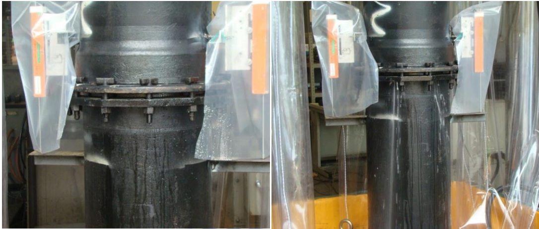
(a)試驗終止時承口拔離插口
