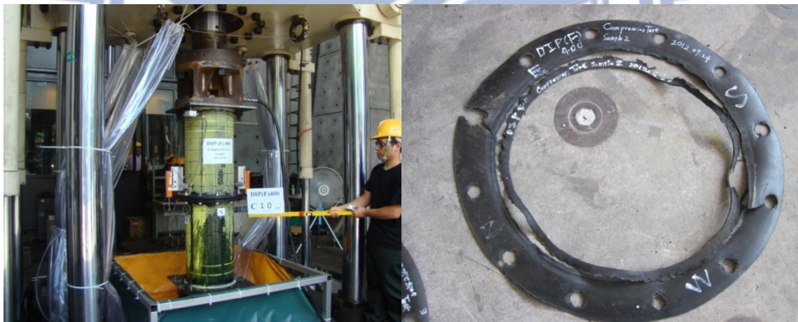
圖 3.58 DIP(F)400-C2 試驗終止情形[34] 圖 3.59 DIP(F)400-C2 試驗膠圈檢視[34]
