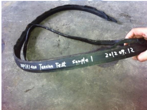
(a) 試驗結束膠圈破壞情形
