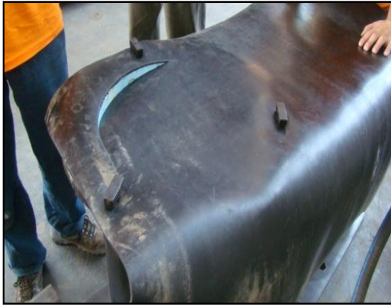
(a) 橡膠片鋪於平口突緣處
