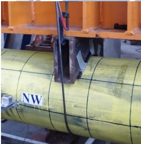
圖 2.42 四點彎矩試驗施力點之 V 型開口治具
