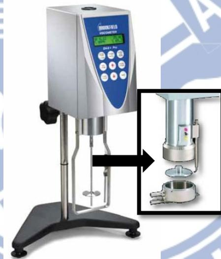
圖 3.7：微電腦觸控型黏度計及椎板式樣品槽。
