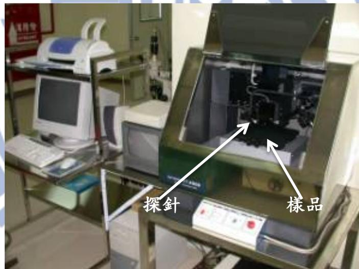
圖 3.5：三維輪廓及表面粗度量測儀。
