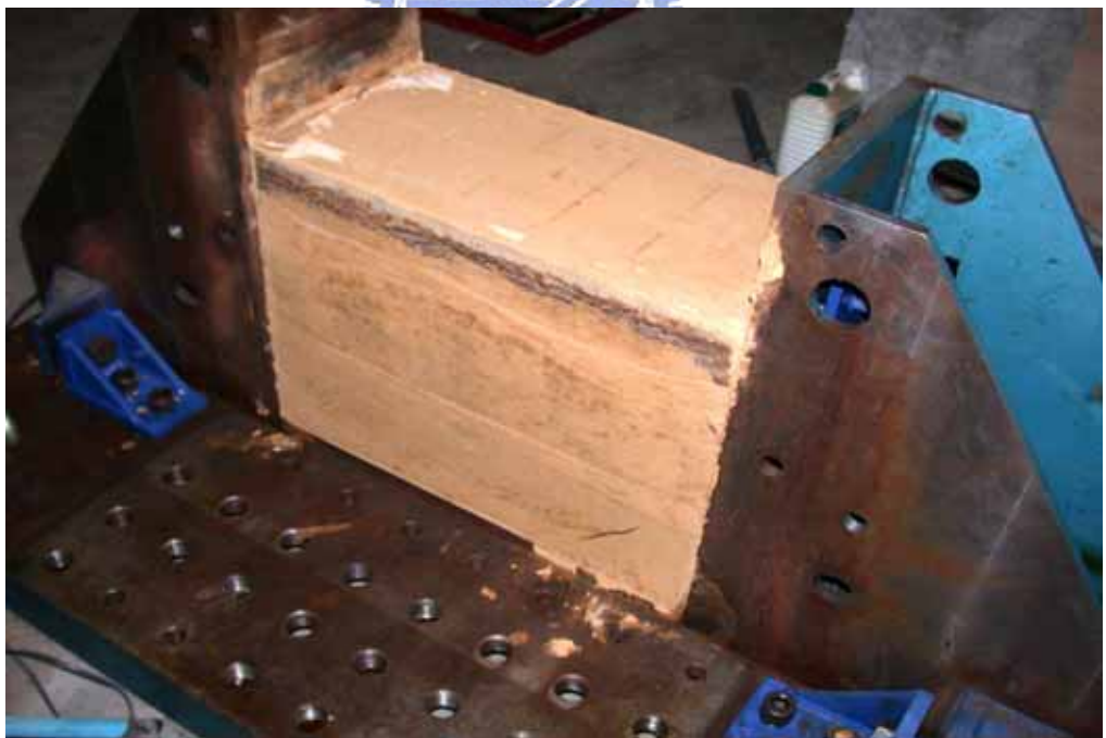
圖 3.12 人造膠結不良砂岩試體拆長邊模氣乾情形
