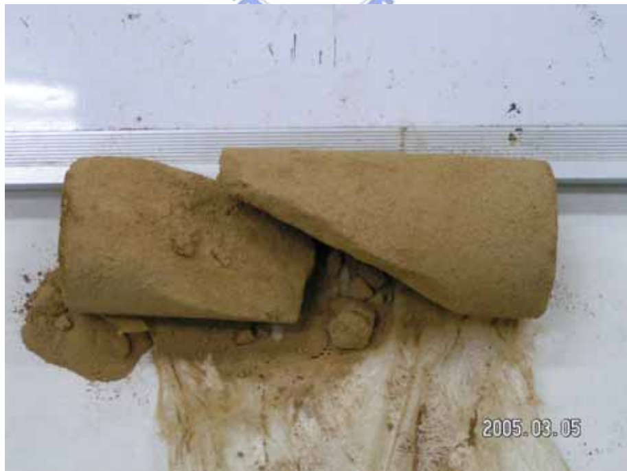
圖 4.15 破碎試體破壞照片
