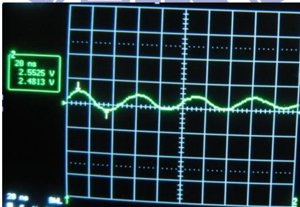
圖 3.26 直流轉換器與低壓差線性穩壓器整合電路 2.5V 輸出時域量測結果
