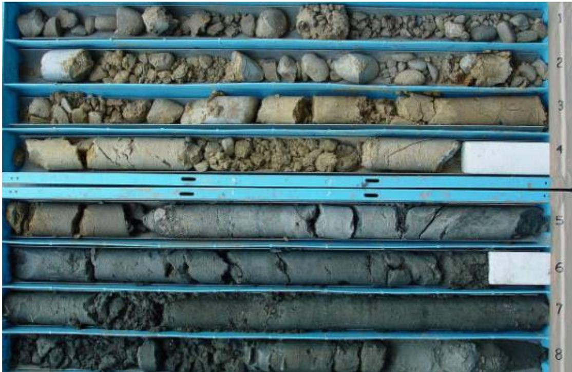
圖 B-14 三姓橋 5 號井 0~8 公尺，1 至 2.4 公尺為地表礫石，2.4 至 4.3 公尺為紅土礫石，紅土礫石有受剪切特徵，4.3 公尺至 5.3 為受剪切的砂質泥與近乎水平的疏鬆細砂斷層接觸(經濟部中央地質調查所)。
