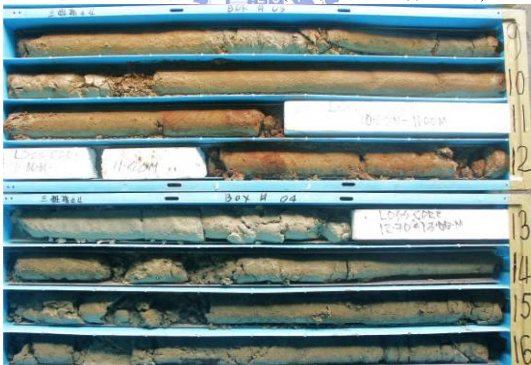
圖 B-13 三姓橋 4 號井，上部的疏鬆細砂遭紅化，砂岩中可見傾角約 50 至 60 度的微斷層(經濟部中央地質調查所)。
