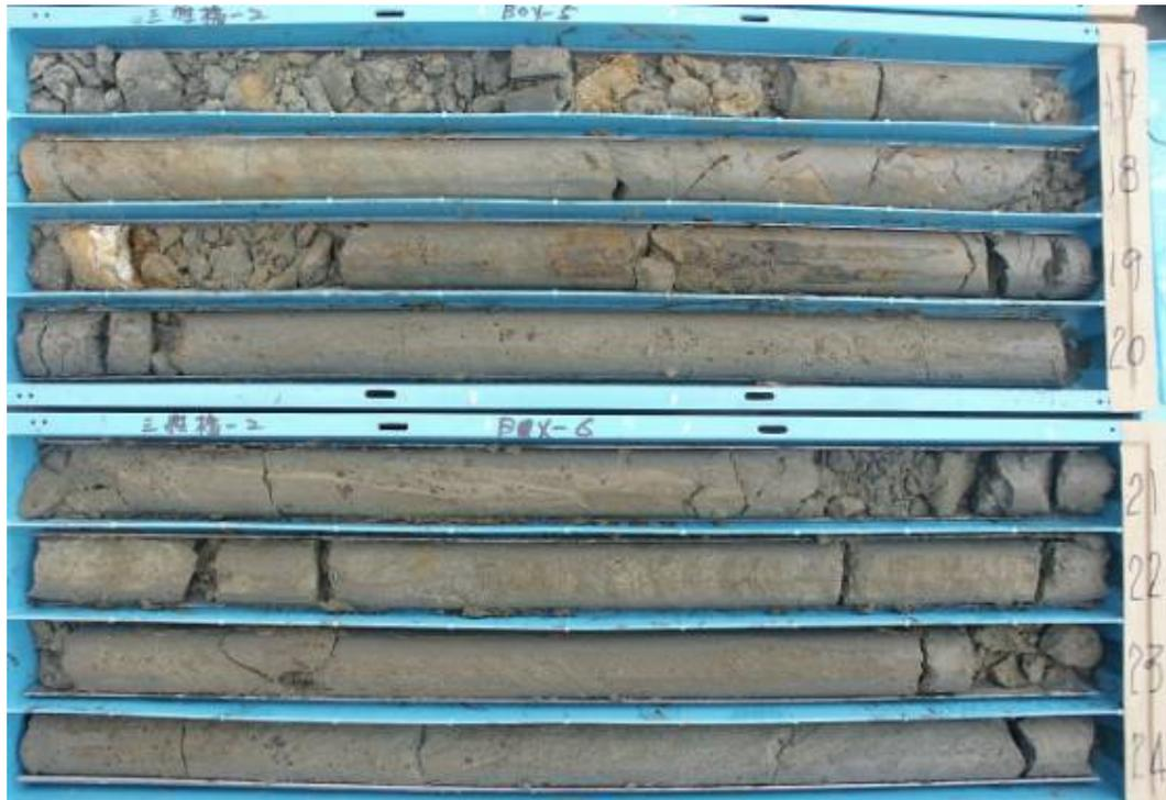
圖 B-12 三姓橋 2 號井，井中疏鬆細砂受高角度微斷層切過，岩層位態由近 30 度變化至近 60 度(經濟部中央地質調查所)。
