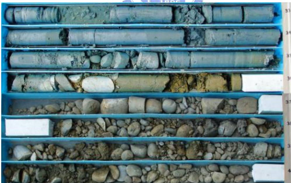
圖 B-15 三姓橋 5 號井 32~40 公尺，受剪切的砂質泥於 35.1 公尺處與礫石層斷層接觸(經濟部中央地質調查所)。
