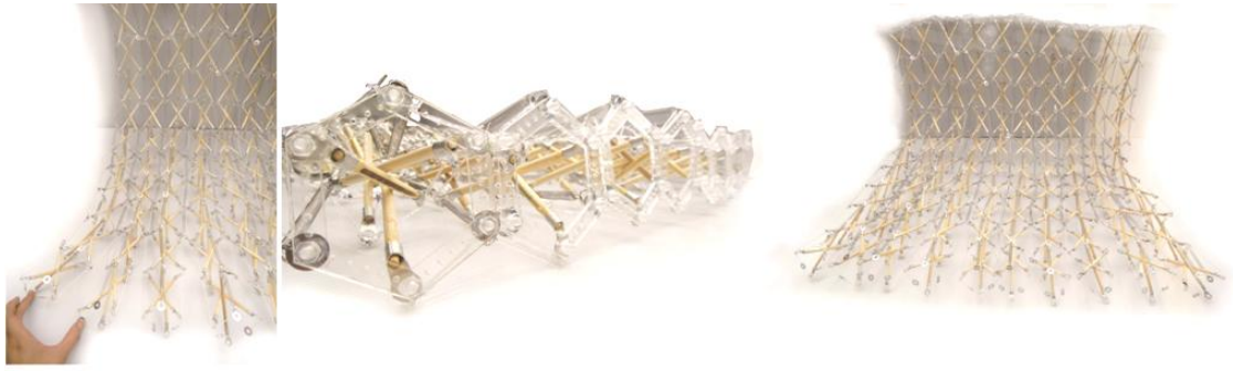
圖表 54 10*10 彈簧矩陣張拉整體系統原型製作
