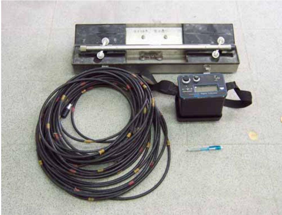
圖 3-1 傳統傾斜儀(IP)
