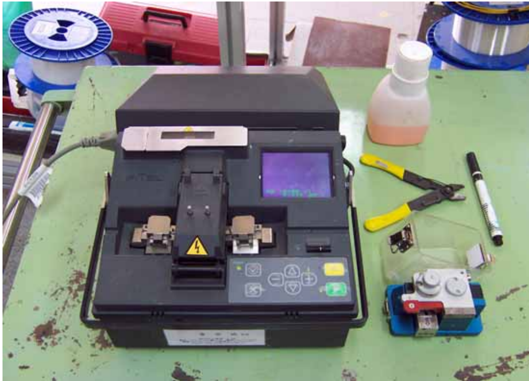
圖 3-3 光纖融接設備
