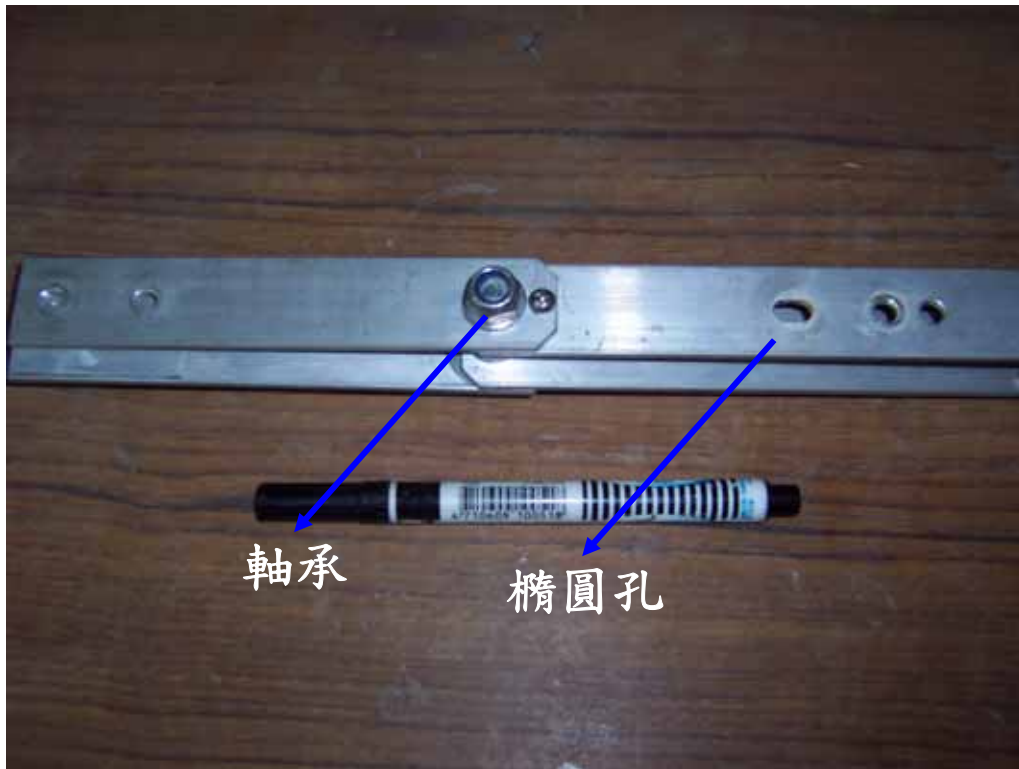
圖 3-10 軸承及滑動端的橢圓形孔
