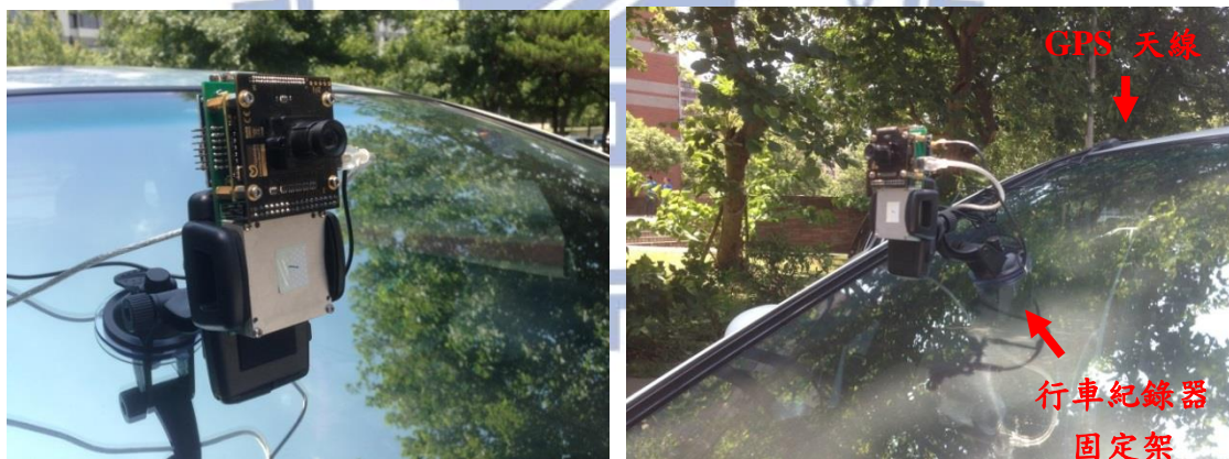
Fig. 5-16 本論文實作的硬體 xGIC 裝設於汽車上的實際圖
