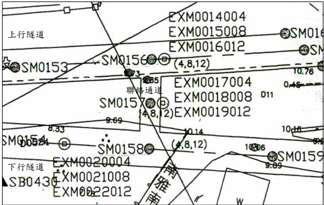
圖 3-10 聯絡通道附近地表監測點(SM)及伸縮儀(EXM)位置
