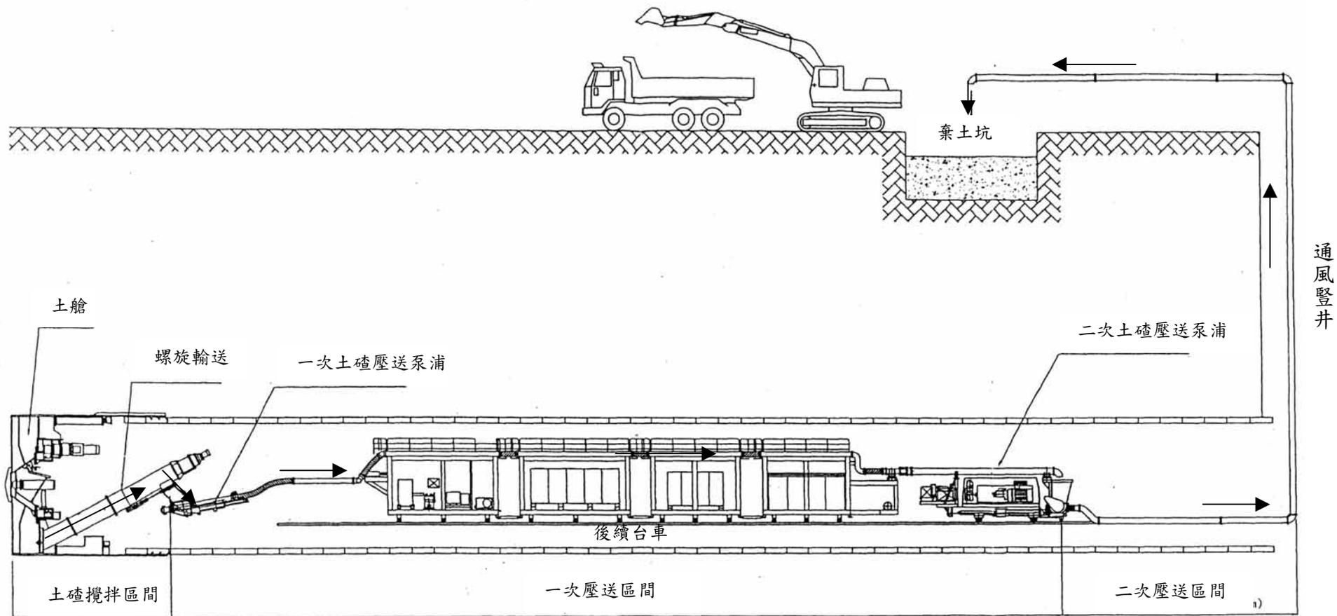
圖 4-7 潛盾隧道土渣排送設備配置圖 (摘自 大陸工程 2003b)
