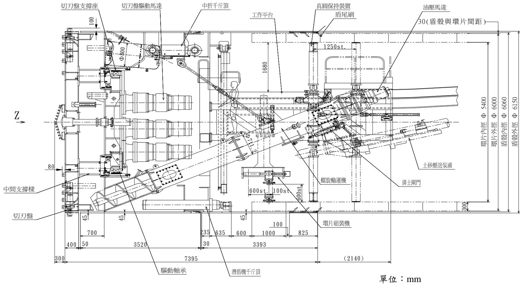
圖 4-5 CB420 標加泥土壓平衡式潛盾機細部構造剖面圖 (摘自 大陸工程 2003b)
