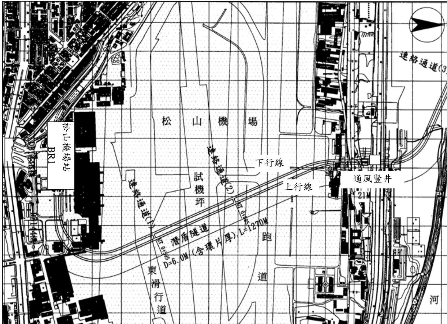
圖 4-3 CB420 標隧道穿越機場平面圖 (摘自 大陸工程, 2003b)
