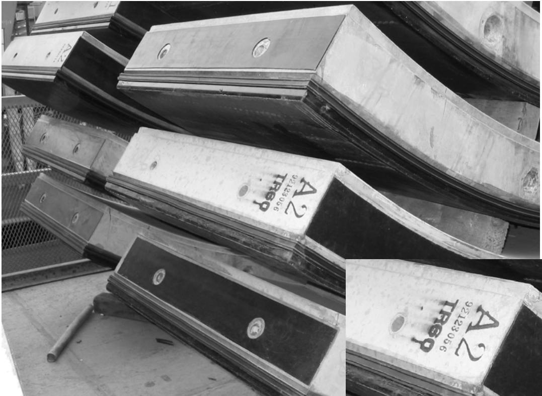
圖 4-12 異形量 60 mm 之隧道襯砌環片
