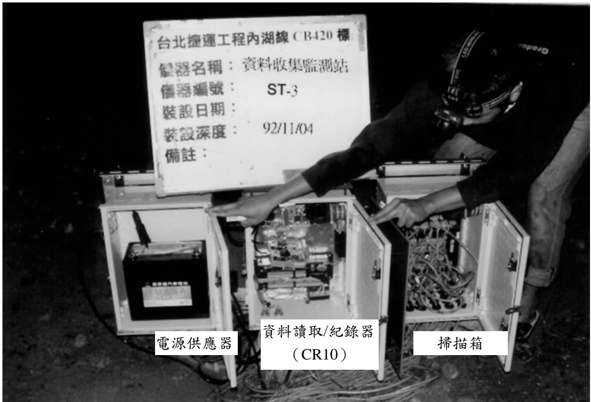
圖 4-28 主跑道南側草坪上之自動監測資料收集站 (ST3) (摘自 捷儀顧問公司 2003)
