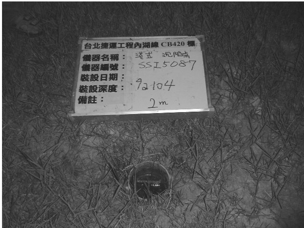
圖 4-22 機場內淺式地表沉陷觀測點 (SSI) (摘自捷儀工程顧問公司 2003)
