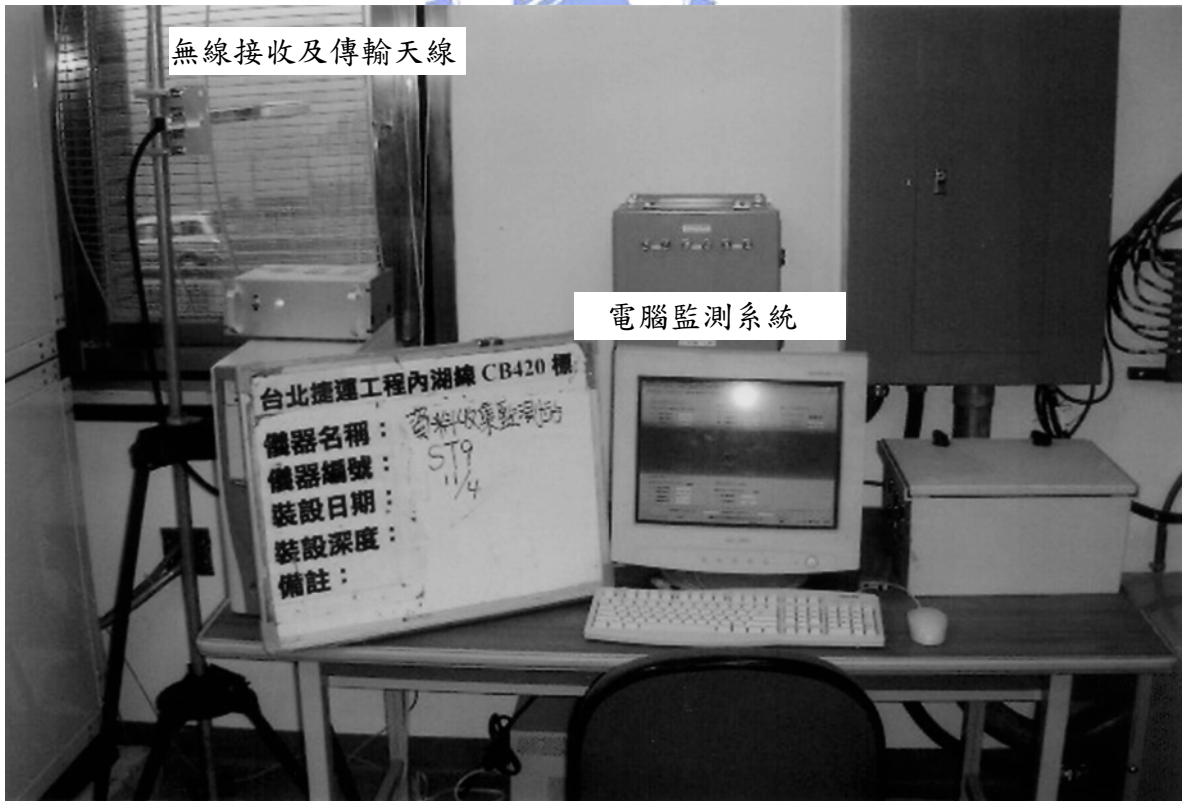
圖 4-29 濱江街雷達站 5 樓之自動監測資料收集接收站(ST9) (摘自 捷儀顧問公司 2003)
