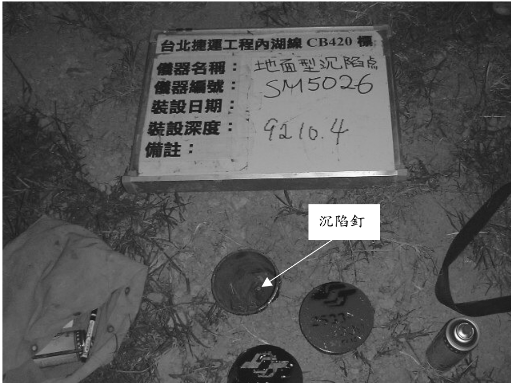
圖 4-19 機場草坪地表沉陷觀測點 (SM) (摘自捷儀工程顧問公司 2003)
