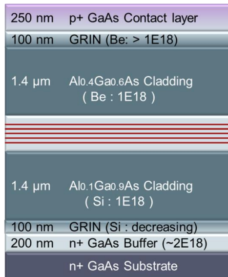
圖 4-1 量子點雷射晶圓(Lm4917)剖面結構示意圖
