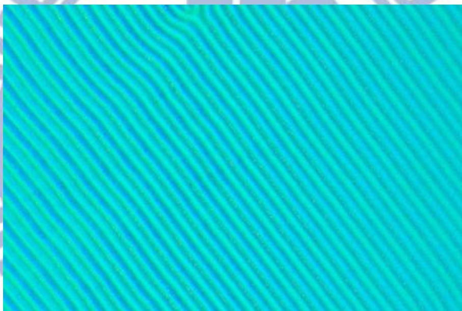
圖 2.17 雙頻橫向螺旋膽固醇液晶態紋理圖。
