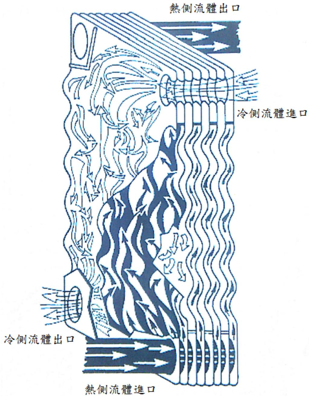
圖 1.4 板式熱交換器流動示意圖[1]
