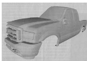
圖 1-49b. 電腦轉換點雲成 NURBS 模型
