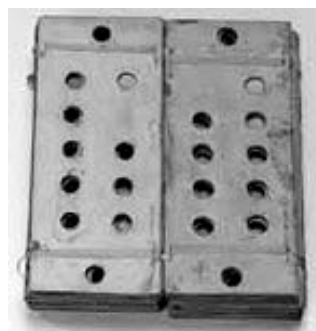
圖 1-34b. 查卡織布機以 Punch Card 作為編織的圖案控制
