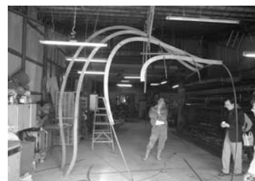
圖 1-57c.雷射切割輸出骨架
