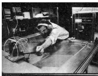
圖 1-52b. 平床式輸出設備
