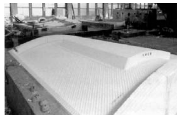
圖 1-55c. .CNC milling 製成的模子
