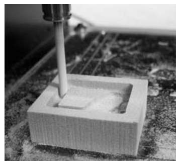
圖 1-36b.銑削堅硬的泡棉
