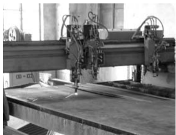
圖 1-58a.雷射切割骨架
