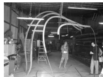
圖 1-26.雷射切割輸出骨架
