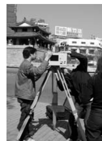
圖 1-48c. 大型遠距掃描器
