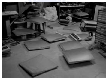
圖 1-25b.曲率不同的壓克力表皮
