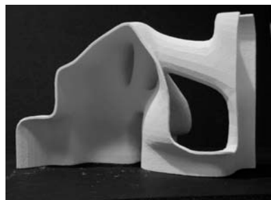
圖 1-41c.粉末硬化之模型
