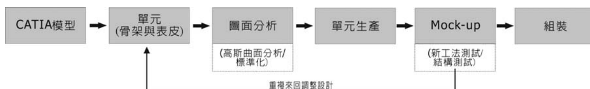
圖 3-57 「數位建構」階段之 CAD/CAM 操作過程
