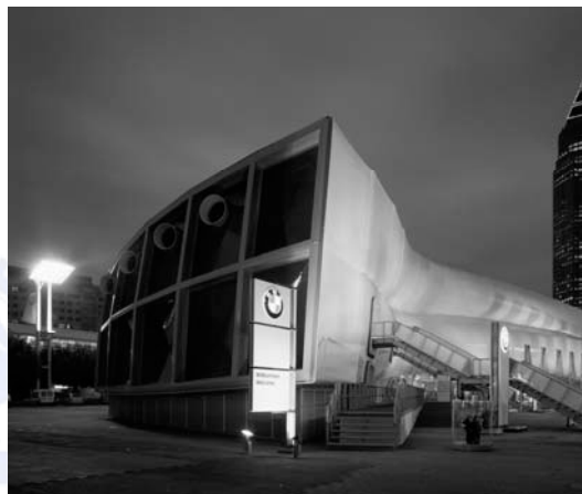
圖 3-104 單向曲度拉張的薄膜系統建築
