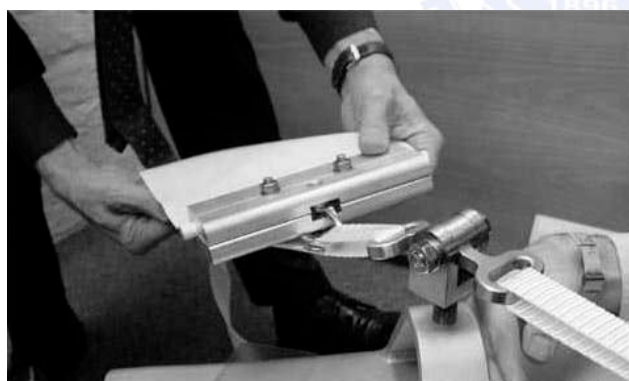
圖 3-91 薄膜固定爪件 1:1 mock-up
