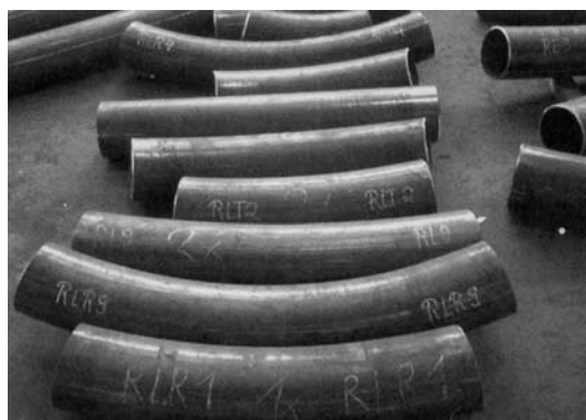
圖 3-74 每段具有編號的彎管單元
