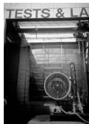
圖 3-26 鈦金屬外牆風力測試
