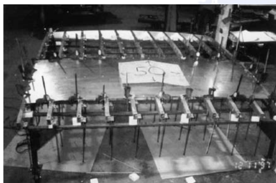
圖 3-50 可重複製作模板的“釘床”(pin mold)
