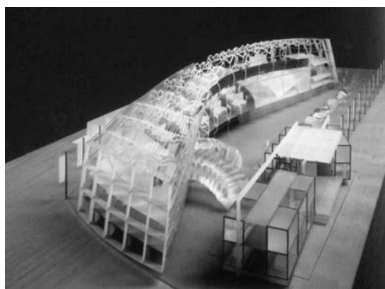
圖 3-88 RP 骨架實體模型(SLA)
