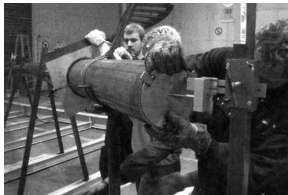
圖 3-77 工廠預組裝(計算旋轉角度)
