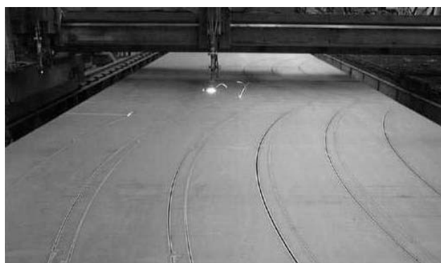
圖 3-95 CNC 雷射切割骨架單元
