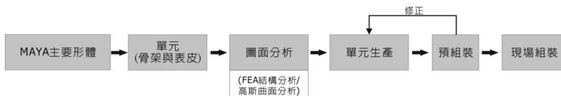
圖 3-82 「數位建構」階段之 CAD/CAM 操作過程
