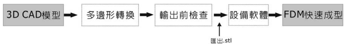
圖 4-27 FDM 快速成型轉檔過程
