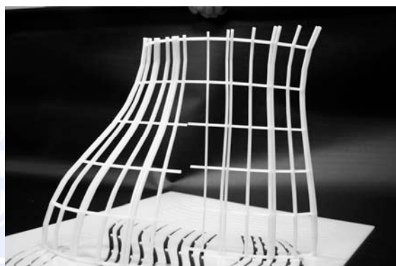
圖 4-9 組裝完成的雷射切割骨架模型
